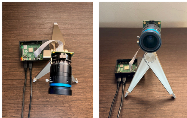
Figura 54 - Câmera de videovigilância com recurso à Raspberry Pi.
