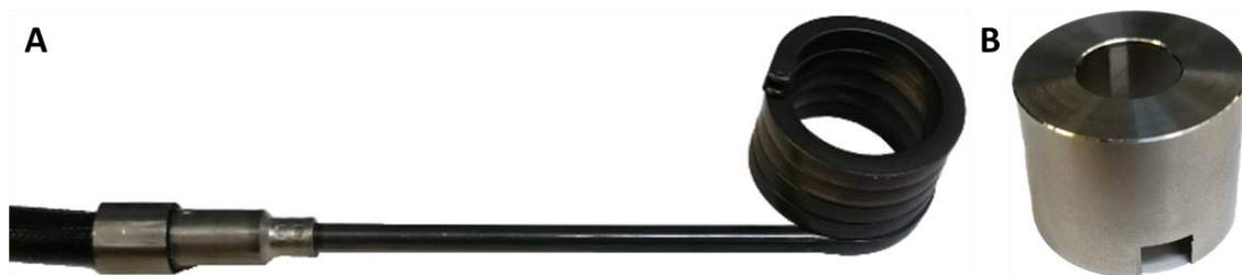
Figura 56 Componentes do CR: resistência (A) e casquilho exterior (B).
