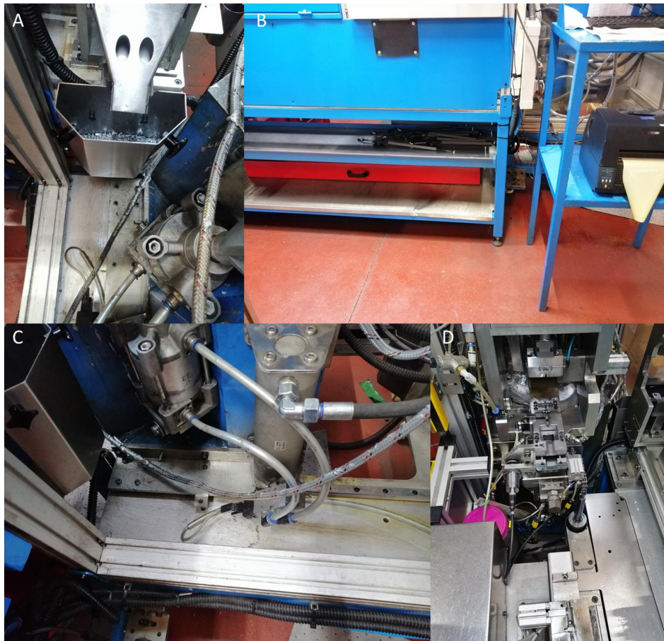
Figura 102 Equipamento um mês após a intervenção: reservatório dos gitos único e garantindo o correto armazenamento dos gitos (A), limpeza da fábrica garantida pelo controlo do percurso dos gitos (B) e do equipamento (C) e (D).
