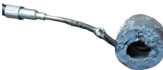
Figura 143 Resistência substituída pela falha causada pela corrosão.
