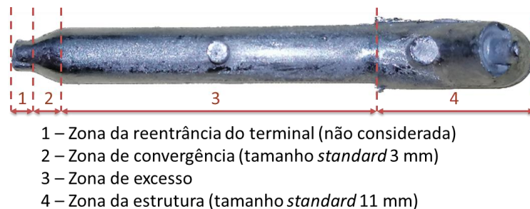
Figura 28 Exemplo de um gito resultante da segunda injeção.
