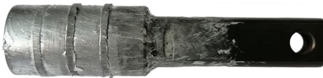
Figura 148 Êmbolo V1 após a realização de 50 injeções.
