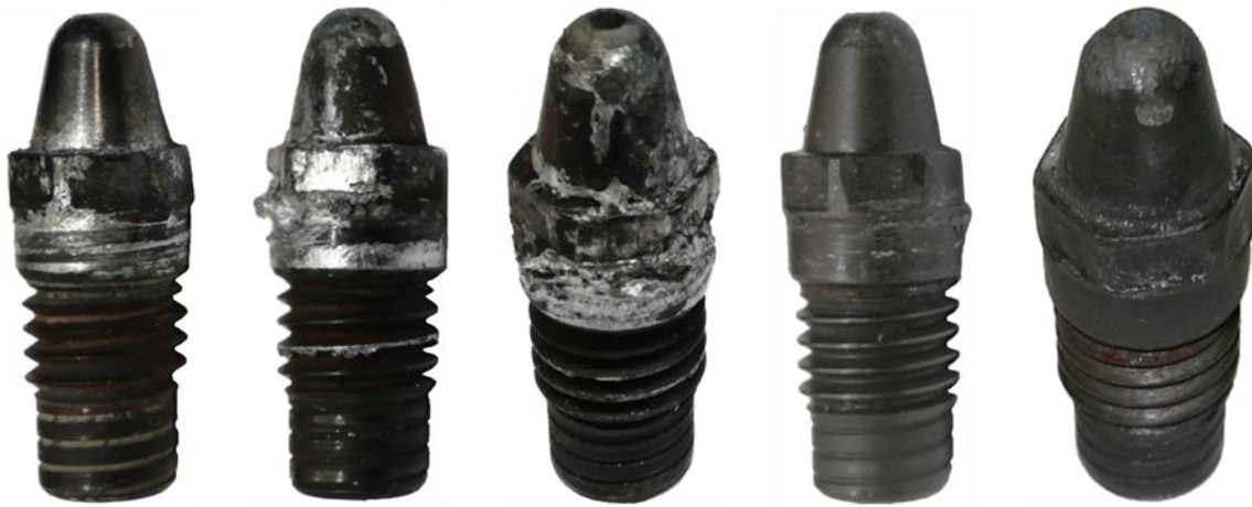
Figura 120 Versões 1.3 do BIZ substituído por desgaste na ZE.
