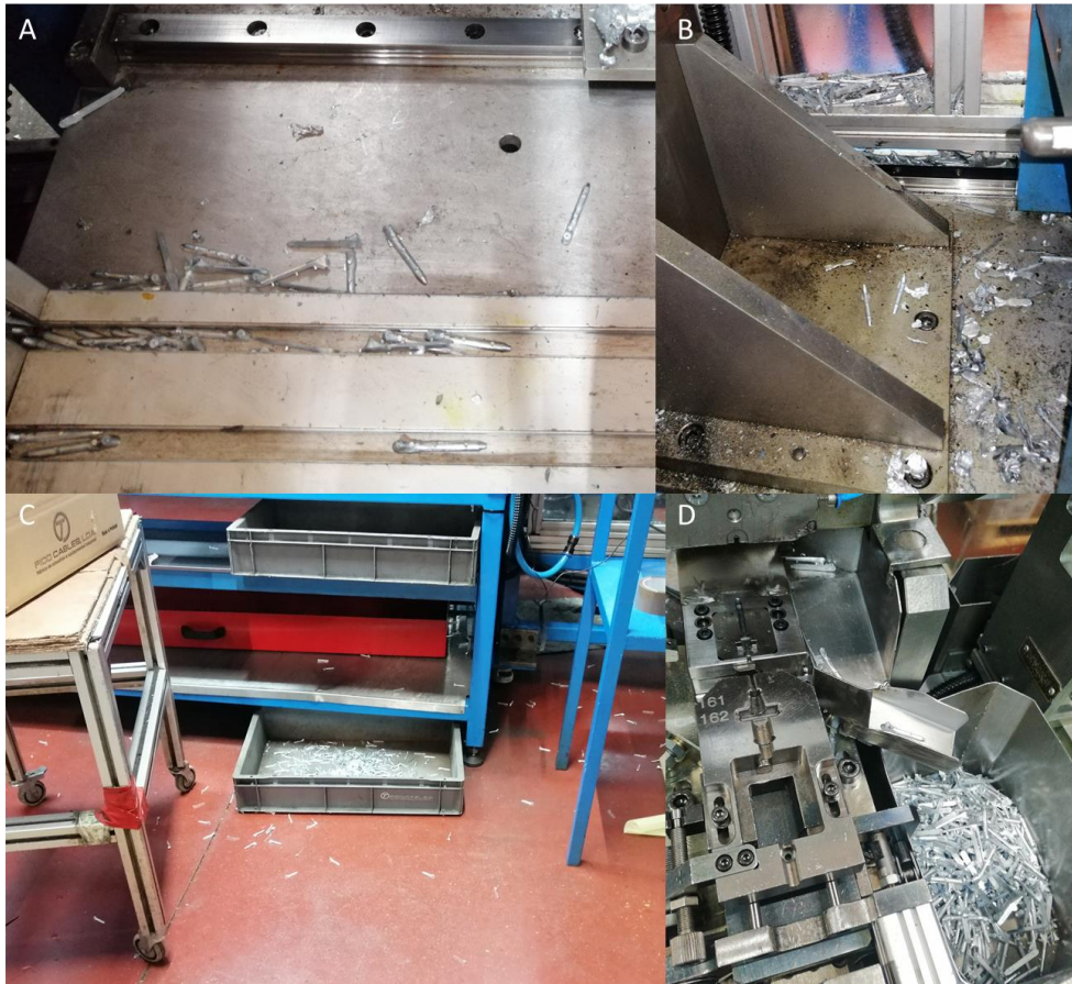
Figura 31 Exemplo da falta de controlo do processo provocada pelos gitos com comprimento excessivo: gitos acumulados no equipamento (A e B), sujidade da fábrica (C) e reservatórios adicionais (D).
