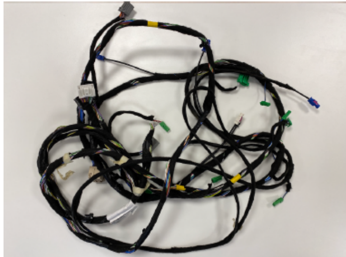
Figura 2.4: Exemplo de um wire harness [12]
