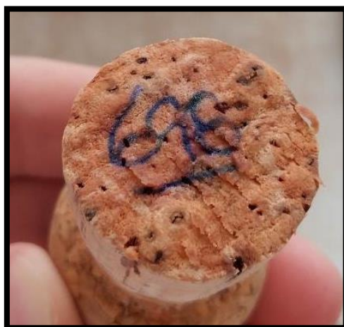
Figura 16. Exemplo da condição visual da rolha onde é possível observar absorção de líquido no disco de espelho.
