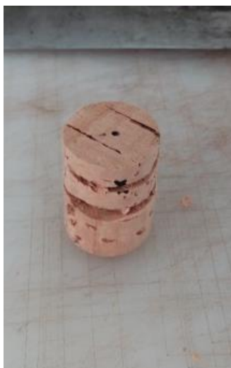
Figura 9. Corte das rolhas em duas secções, superior contaminada e inferior não contaminada.
