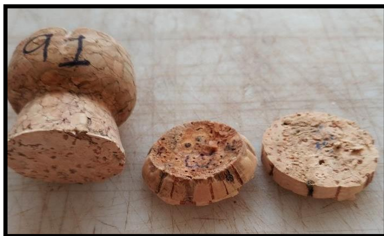
Figura 15. Exemplo da condição visual após abertura da garrafa. Disco de espelho (centro) com colapso da estrutura.
