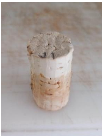
Figura 11. Exemplo da análise visual das rolhas, aos 24 meses, após extração.
