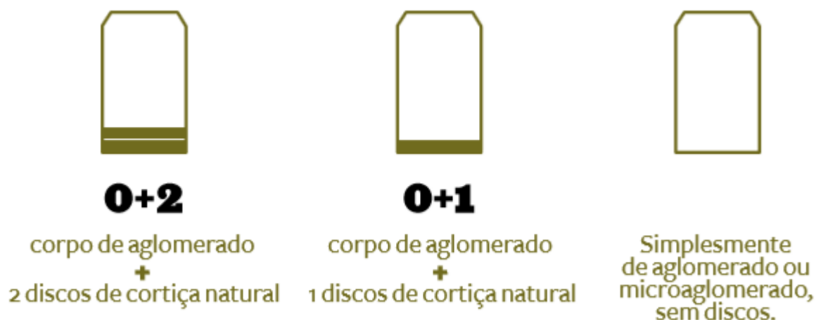
Figura 3. Diferenças entre os tipos de rolhas de champanhe [9].
