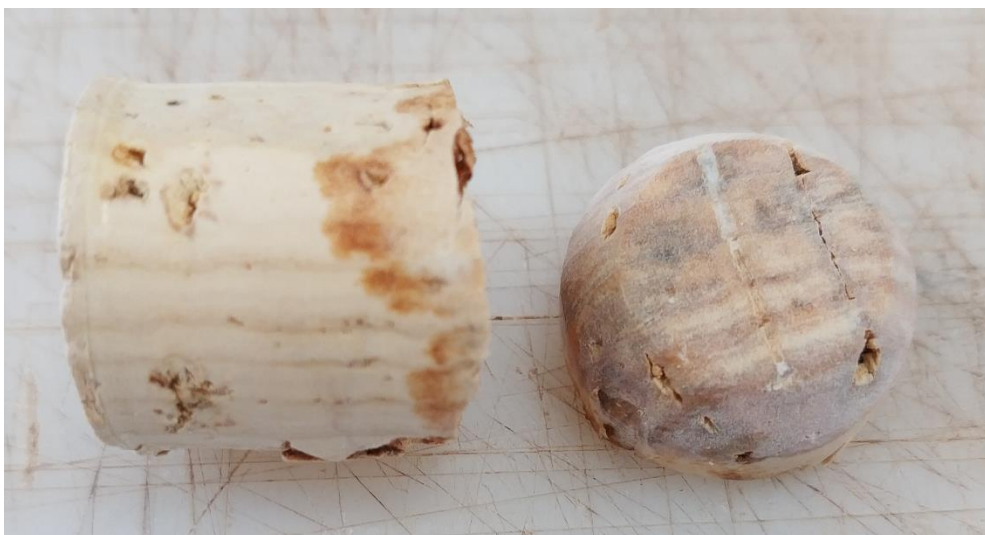
Figura 13. Exemplo da absorção de líquido pela rolha que atinge a secção contaminada. Partes castanhas da rolha representam locais humidificados.
