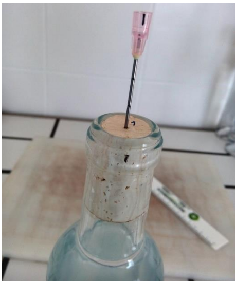
Figura 8. Contaminação da rolha com solução de d5-TCA utilizando uma seringa.
