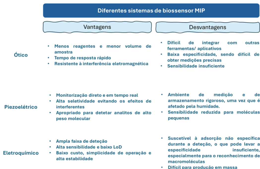
Figura 19. Esquema de comparação dos diferentes sistemas de biossensores. Imagem adaptada de (Li et al., 2024).
