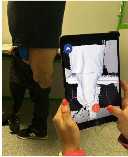
Figura 5.18: Digitalização de um membro residual com recurso a um scanner 3D
