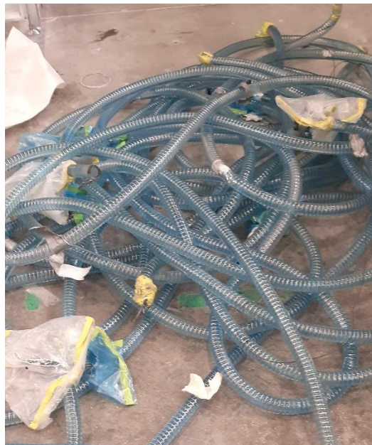
Figura 33 - Mangueiras após o processo de infusão com resina catalisada.
