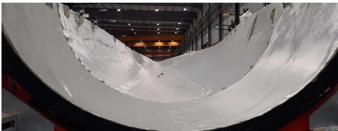
Figura 17 - Camadas de fibra colocadas no molde Maln Shell .
