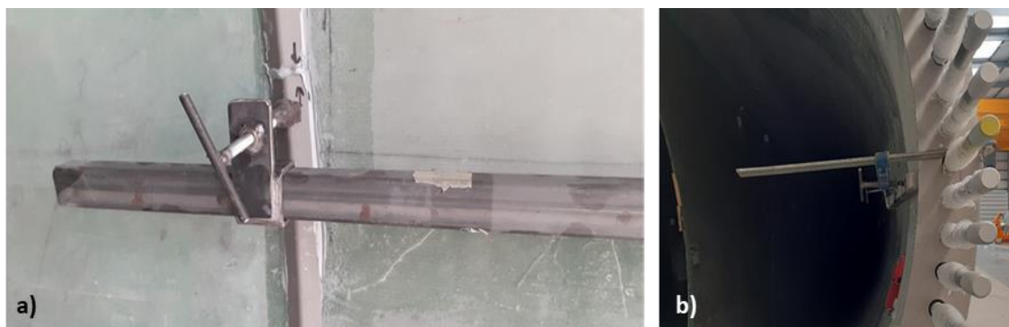
Figura 37 - Detalhes do Jig de aperto: a) no cover e b) na pá.
