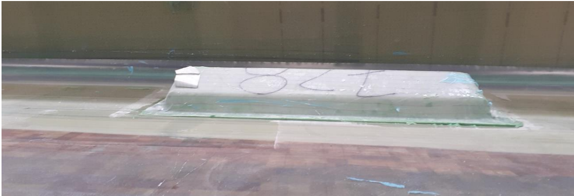
Figura 40 - Calibrador colado na pá.
