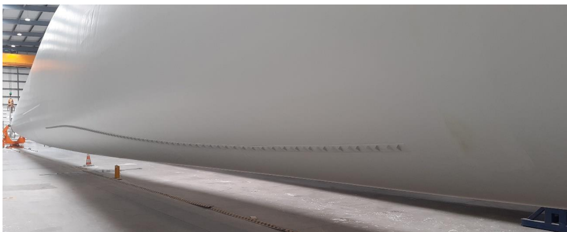
Figura 38 - VGs montados ao longo da pá.
