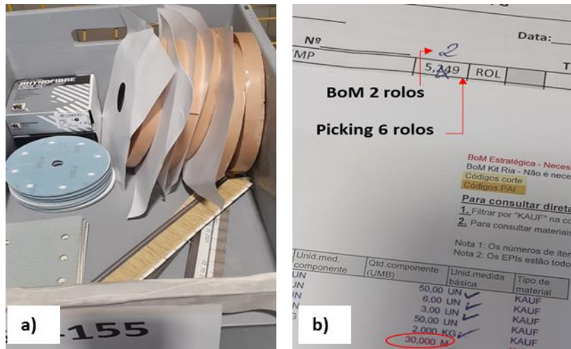
Figura 52 - Abastecimento de materiais em excesso a) por picking list desatualizada b).
