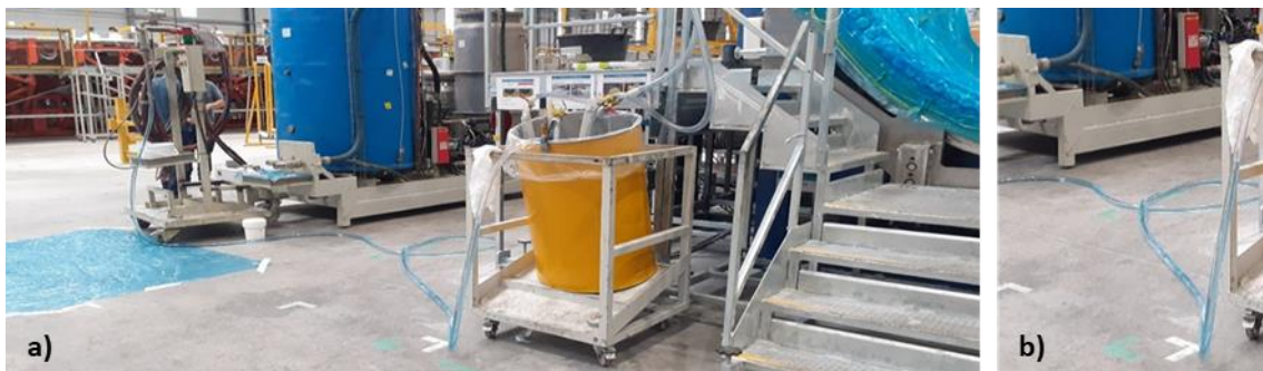
Figura 31 - Mangueira em excesso: a) fotografia do processo de transferência de resina e b) evidência de mangueira em excesso.
