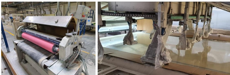
Figura 7 Máquina de pintura UV por rolo (à esquerda) e cabine de pintura spray (à direita). Fonte autor
