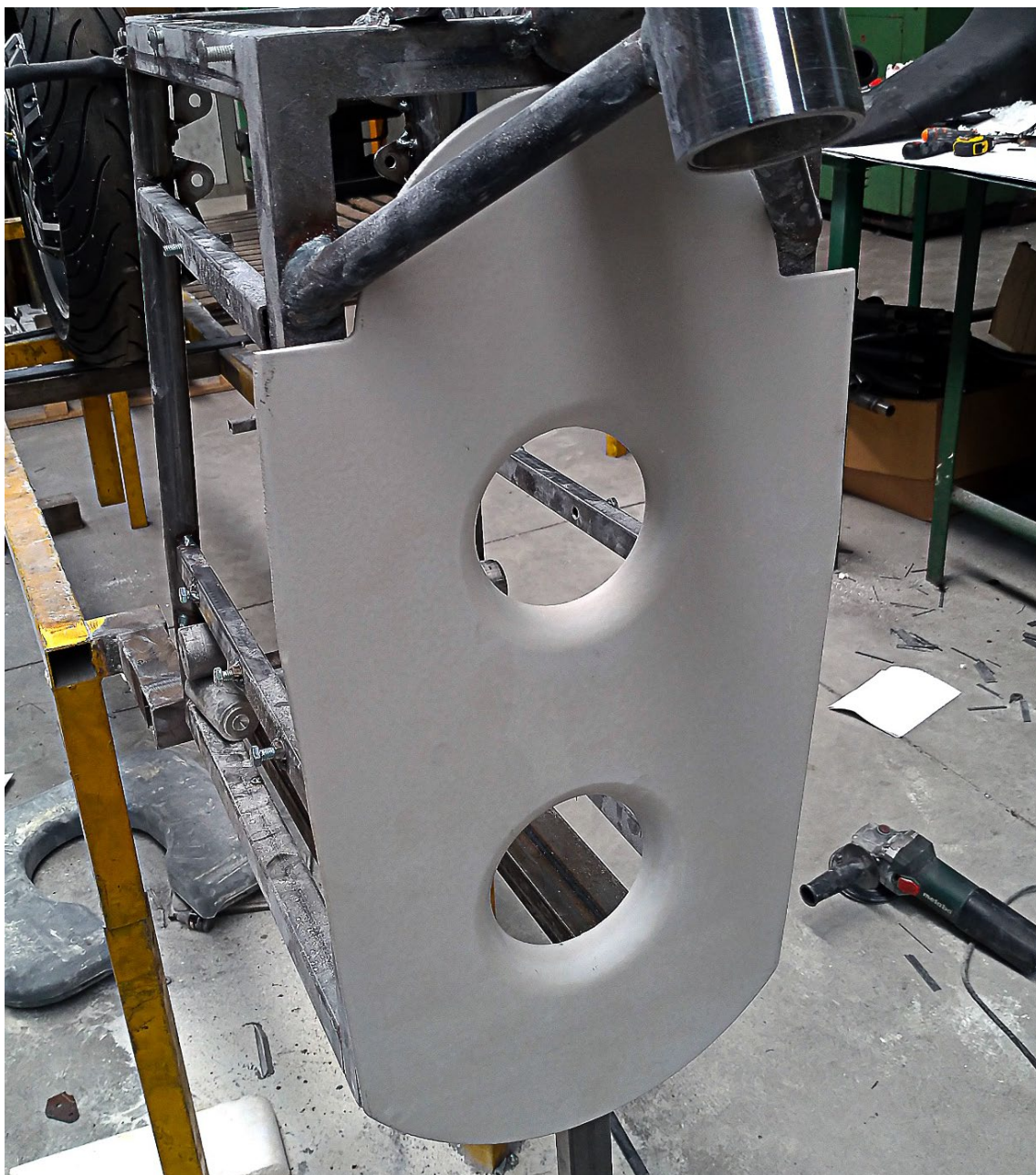
Figura 147 - Preparação da superfície pós-aplicação do primário (quartela frontal do corpo central)
