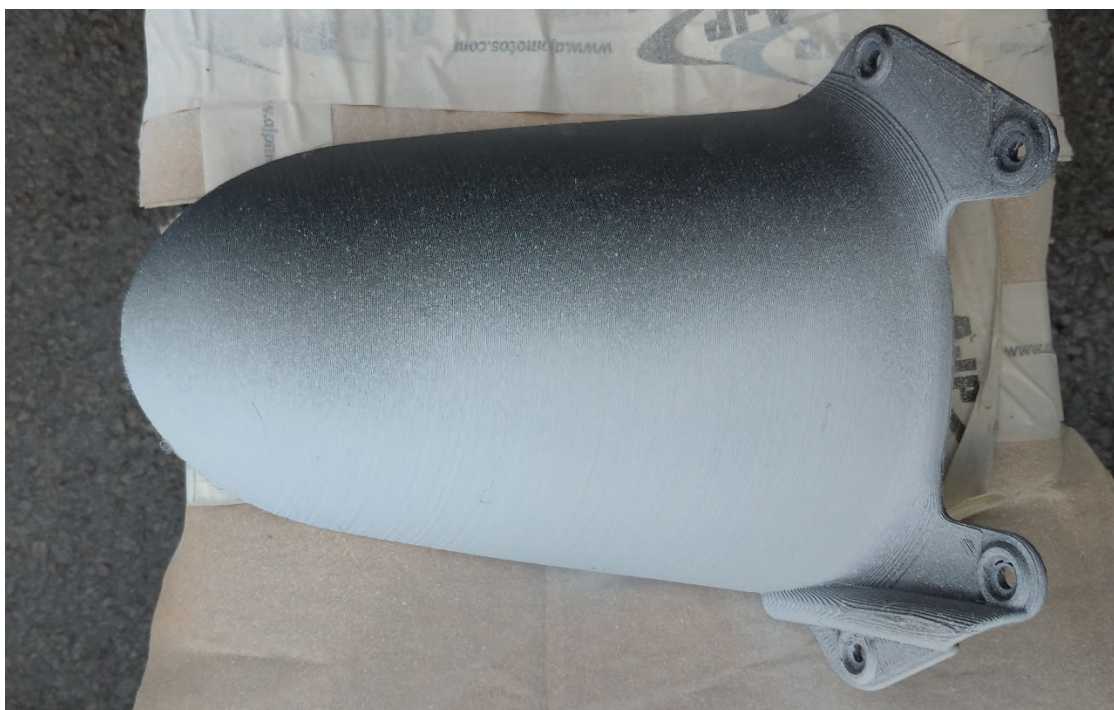
Figura 144 - Aplicação do primário na peça (para-lamas traseiro)
