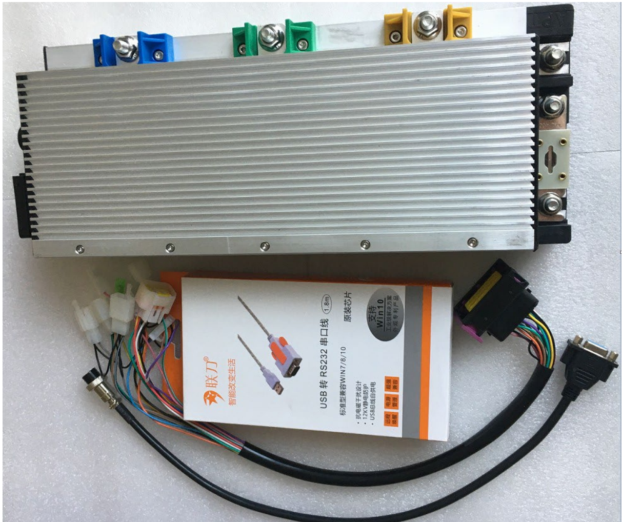
Figura 105 - Controlador eléctrico: APT AE1405
