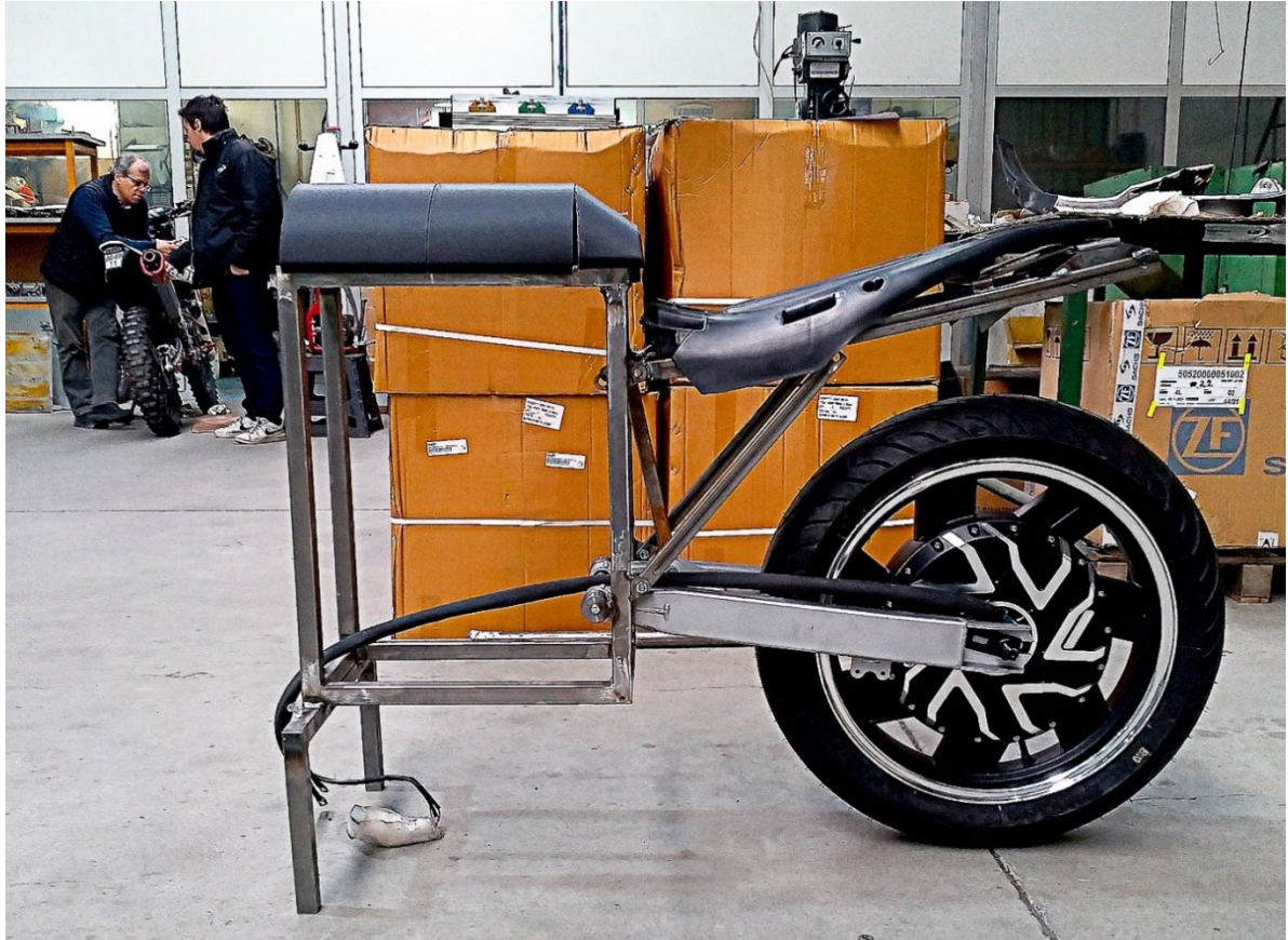
Figura 137 - Gabarito com a estrutura posterior
