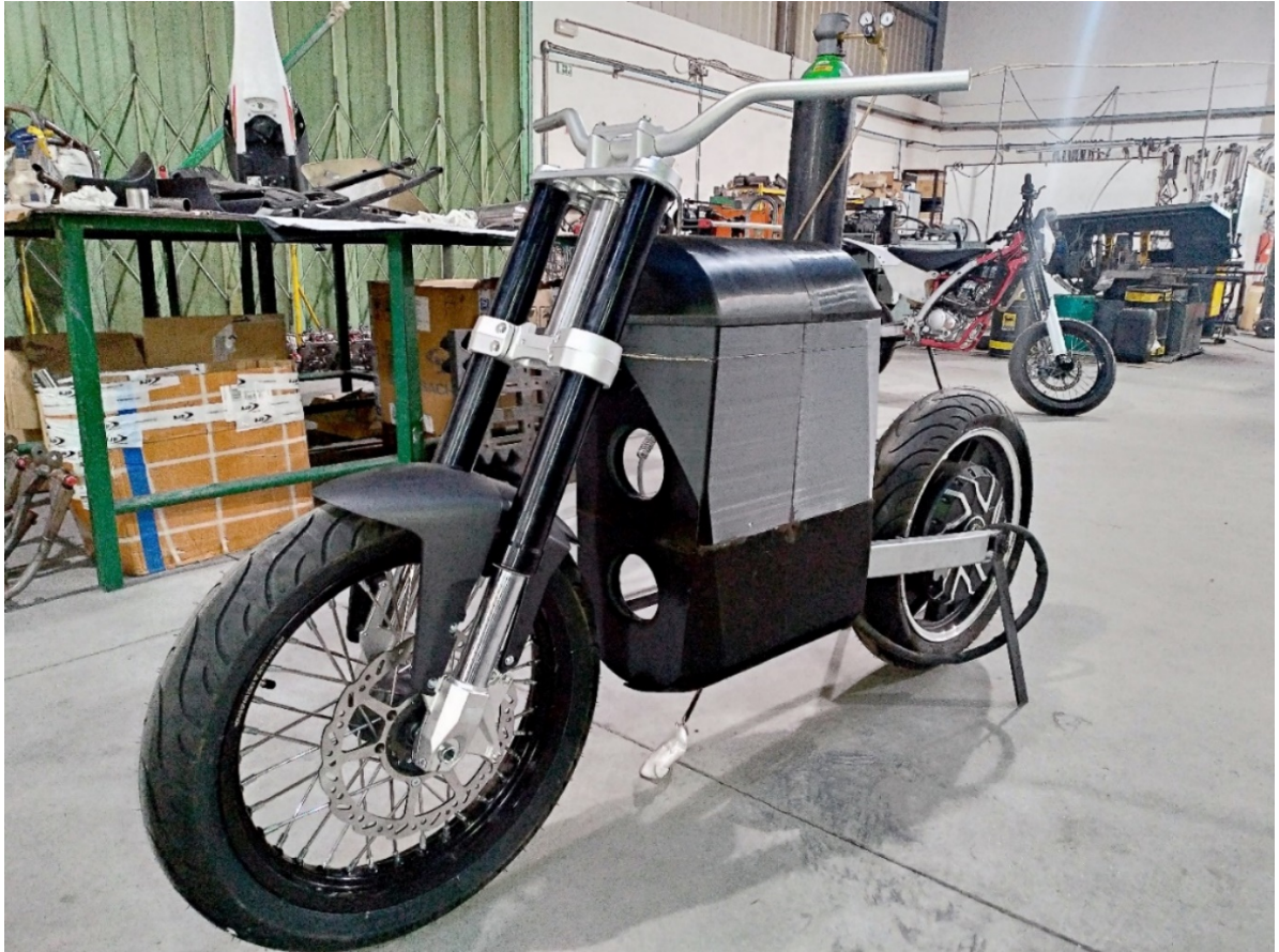
Figura 139 - Instalação dos painéis laterais
