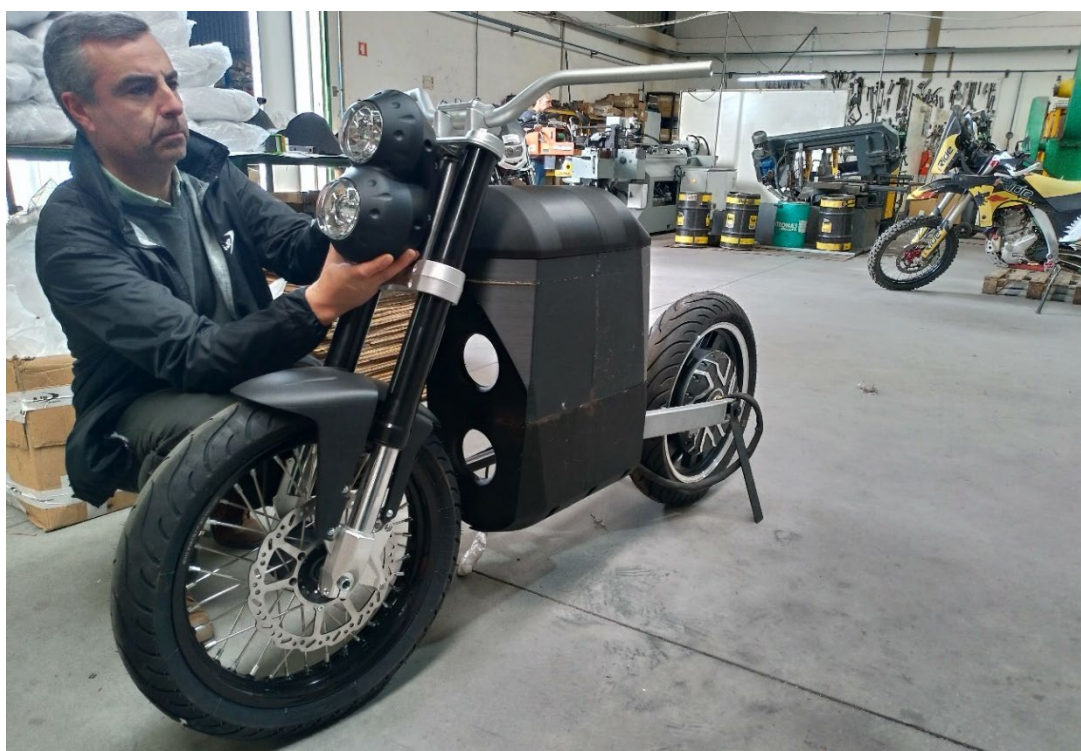
Figura 112 - Testes visuais do farol da AJP PR7 no veículo
