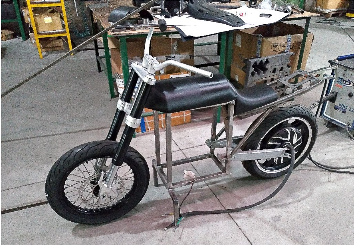
Figura 138 - Gabarito com rodas instaladas
