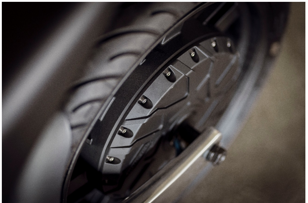
Figura 169 - Vista detalhe secção traseira (motor eléctrico)
