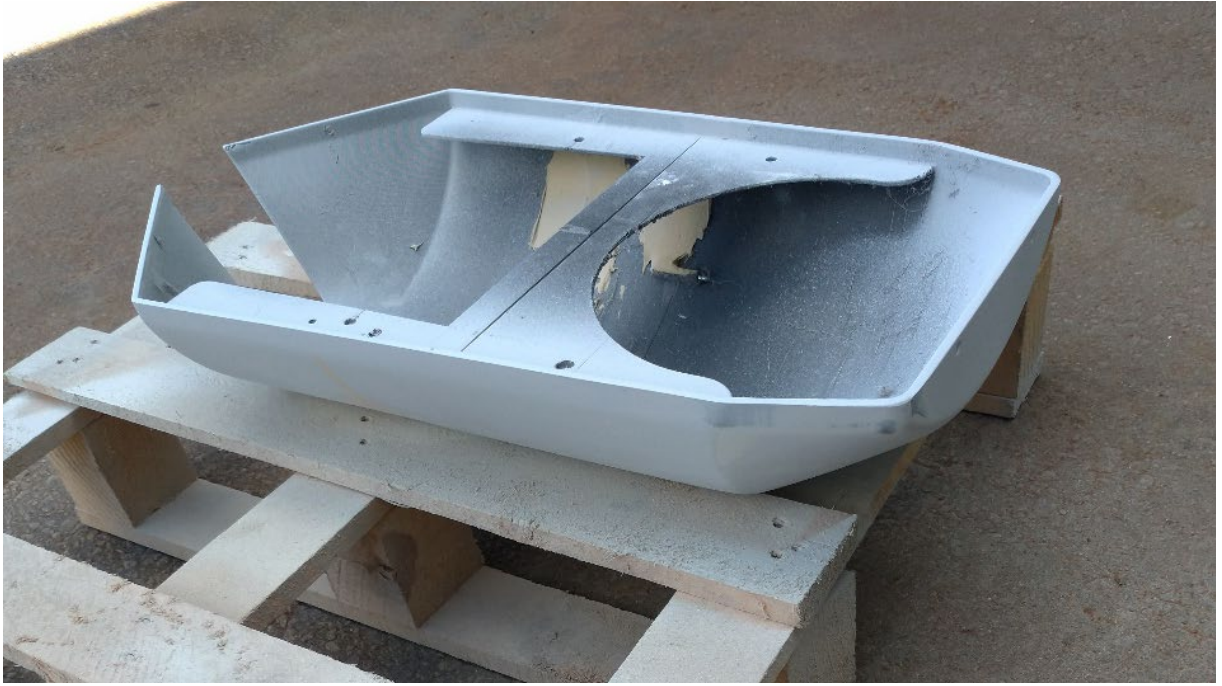
Figura 145 – Aplicação do primário na peça (quartela superior do corpo central)
