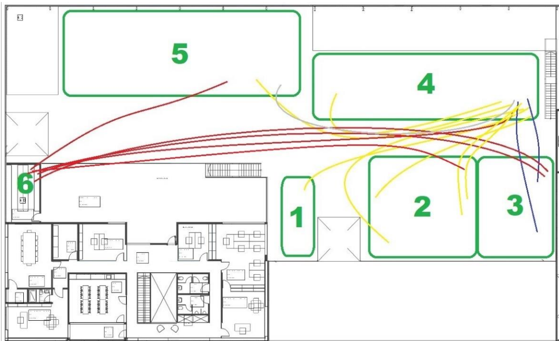
Figura 35- Diagrama de spaghetti montagem 2
