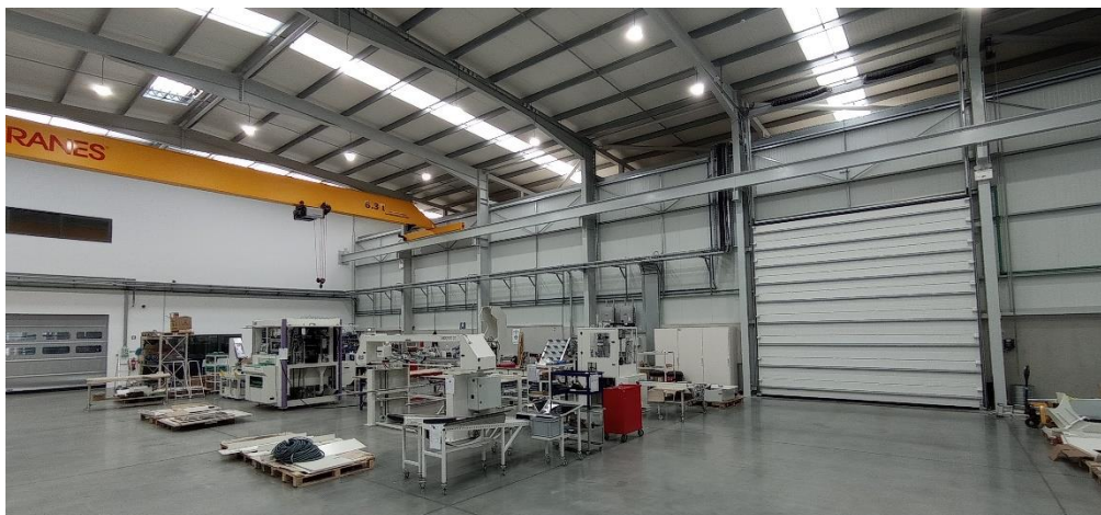
Figura 36 - Exemplo do chão de fábrica sem demarcação
