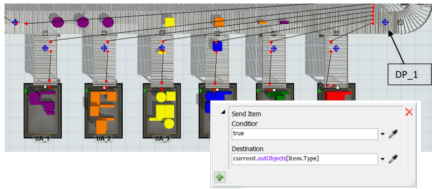
Figura 5.5: Definição de parâmetros no DP1
