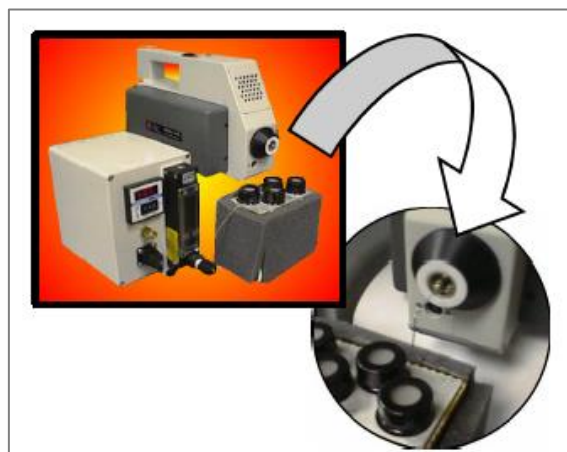
Figura 2.9 - Versão portátil de um nariz eletrónico (“zNose”) agregado a um suporte de amostras para volumes de 40 mL com controlo de temperatura (Staples et al., 1994).
