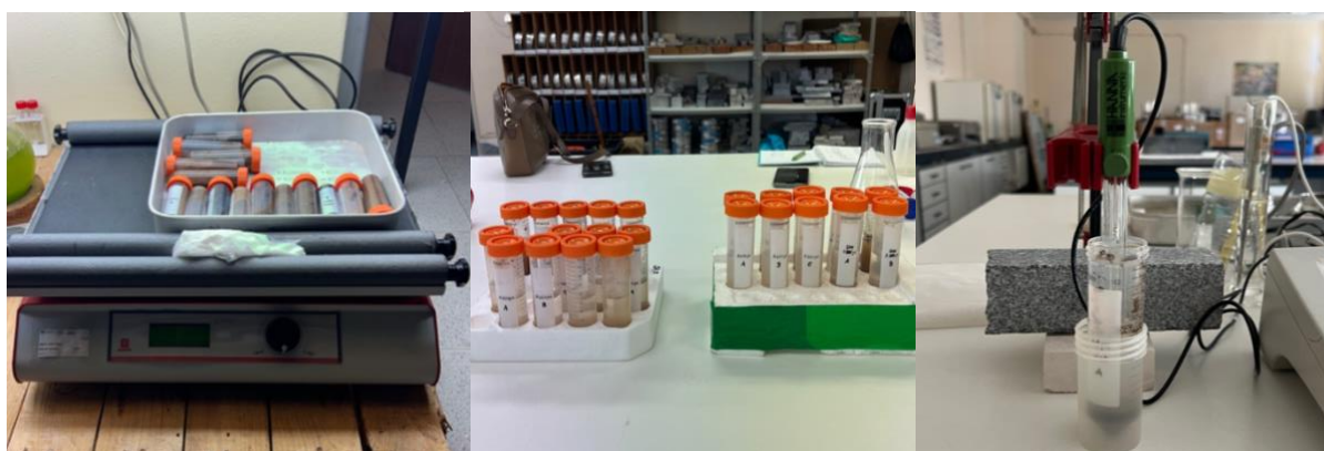
Figura 14. Determinação do pH. Amostras no agitador mecânico (imagem à esquerda), amostras em repouso (imagem ao centro) e medição do pH (imagem à direita).
