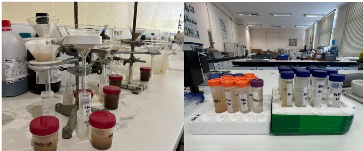
Figura 15. Determinação da condutividade elétrica. Filtragem da amostra agitada (imagem da esquerda) e amostra filtrada preparada para medição da condutividade elétrica (imagem da direita).
