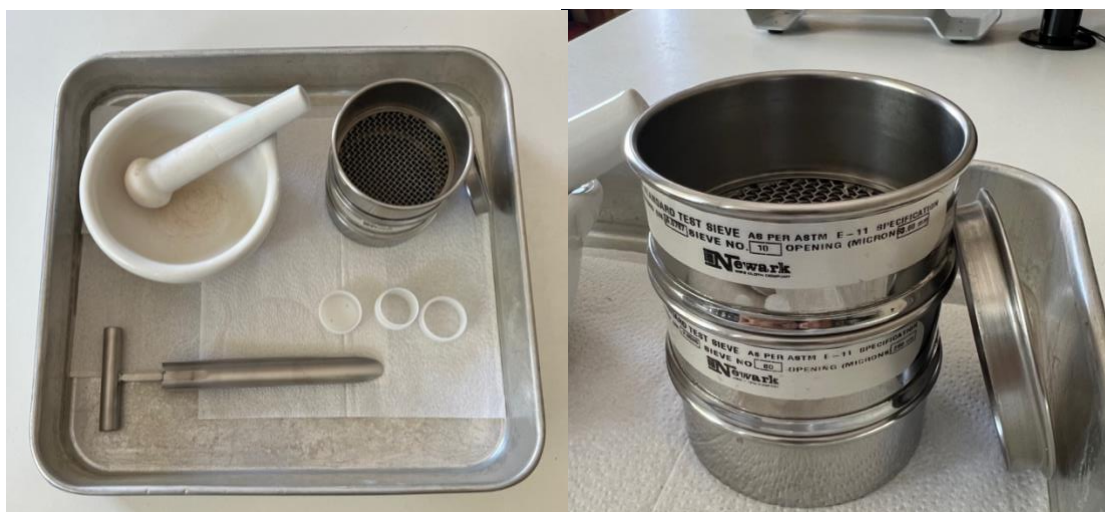
Figura 11. Análise química elementar simplificada por fluorescência de raios-X - equipamentos utilizados na preparação das amostras.
