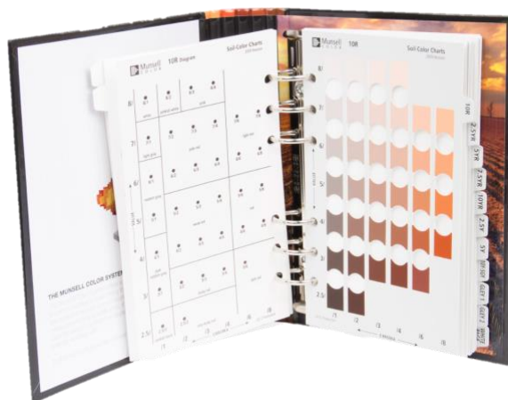
Figura 2. Carta de Cores de Munsell utilizada para a identificação da cor dos solos. (Fonte: https://www.pantone.com.br/loja/munsell/escala-munsell-de-cores-de-solos ).
