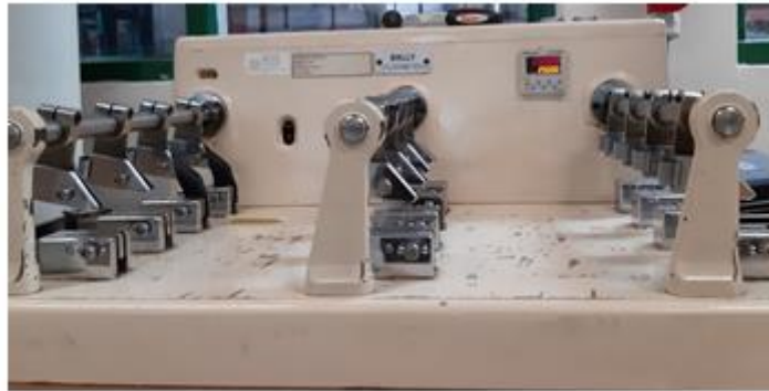
Figura 3.6-Flexómetro Bally G 140 para o ensaio da resistência à flexão
