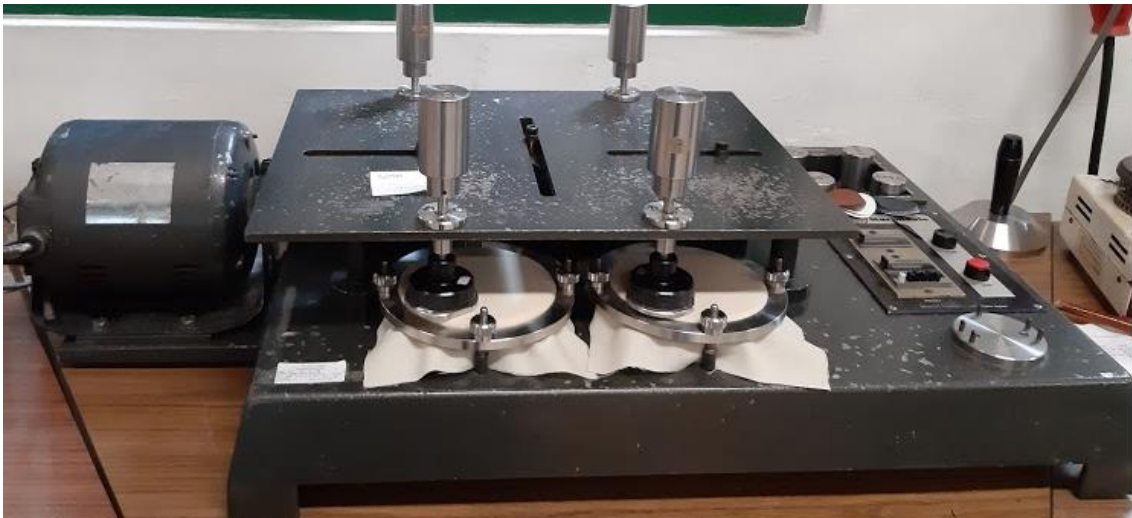
Figura 3.7-Abrasímetro ‘ ‘ Martindale’ ’ usado para o ensaio da resistência à abrasão
