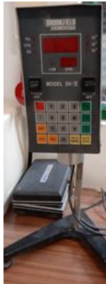
Figura 3.4-Viscosímetro de Brookfield DV-II usado para medir as viscosidades das pastas de PVC
