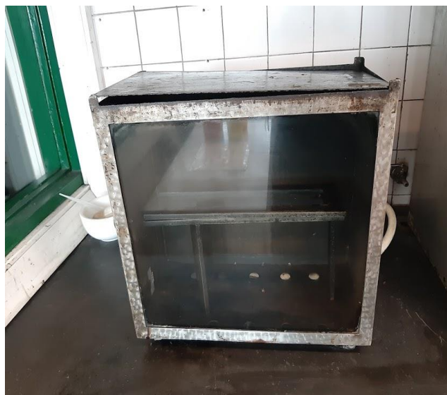
Figura 3.2-Câmara de aço inoxidável com o porta amostra por dentro, usado no ensaio de combustibilidade
