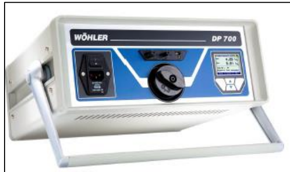
Figura 40 – Equipamento utilizado na realização do ensaio de estanquicidade.
