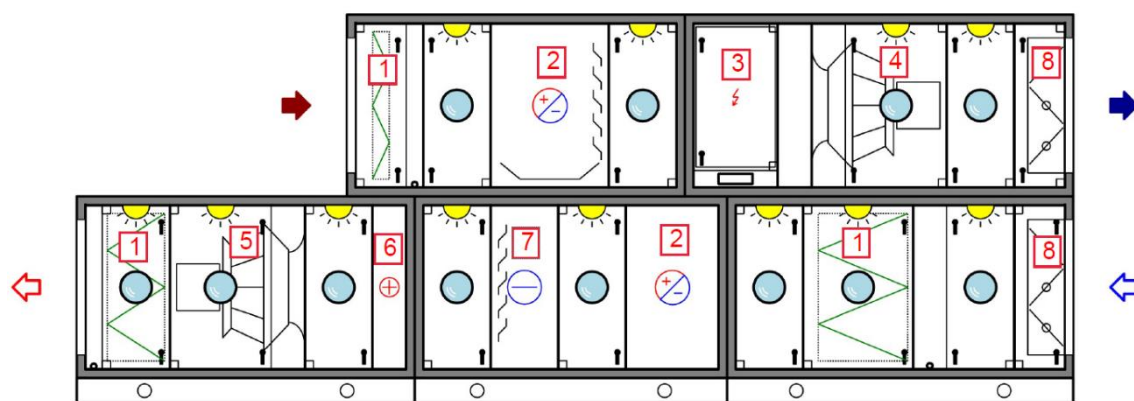
Figura 31 - Esquema de princípio da Unidade de Tratamento de Ar Novo na fase PCC.
