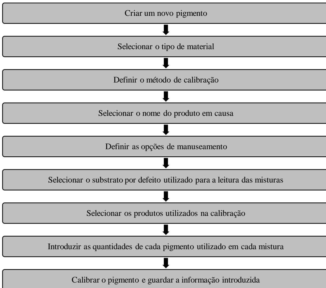
Figura C. 1 – Procedimento a seguir para a criação de um pigmento no ficheiro gerado.
