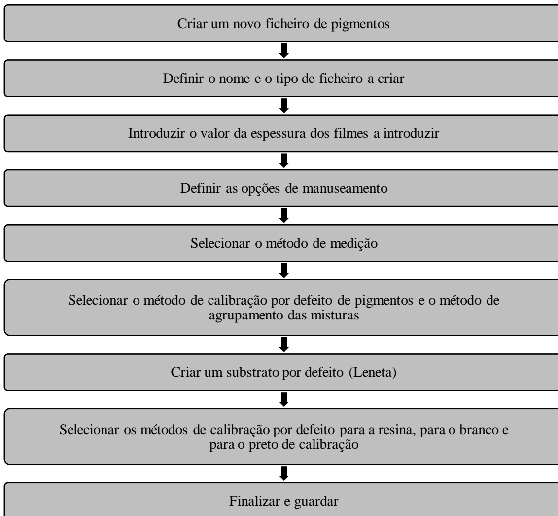
Figura B. 1 – Procedimento a seguir para a criação de um ficheiro de pigmentos no Set Maintenance .
