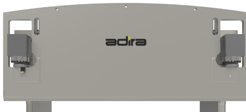
Figura 38 - Disposição dos cilindros hidráulicos utilizados atualmente na quinadora PH040040.
