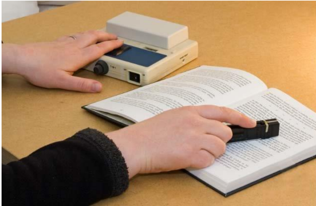
Figura 2 – Optacon, primeiro dispositivo OCR criado (Brewster, 2008)
