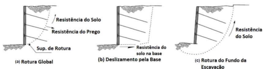
Figura 66 - Modos de rotura externos de muros pregados (Nunes, 2013).
