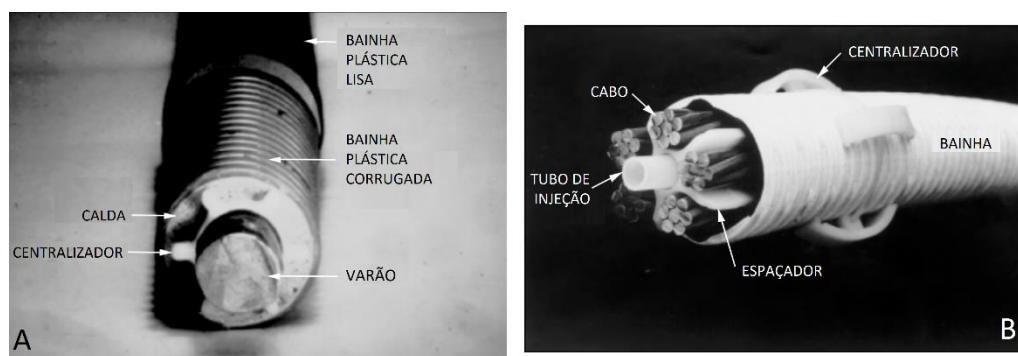
Figura 39 - Armaduras de pré-esforço: barra (A) ou cordão (B), adaptado de (Sabatini et al. , 1999).
