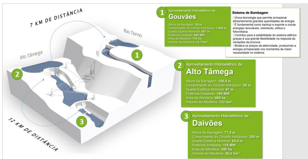
Figura 14 - Esquema da Sistema Electroprodutor do Tâmega
