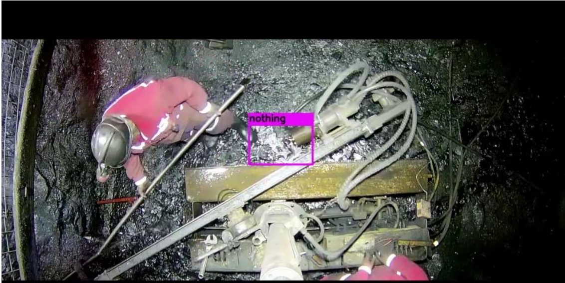
Figura 4 - Detecção automatizada de situações inseguras na utilização de equipamentos em minas de carvão através da Mine Brain
