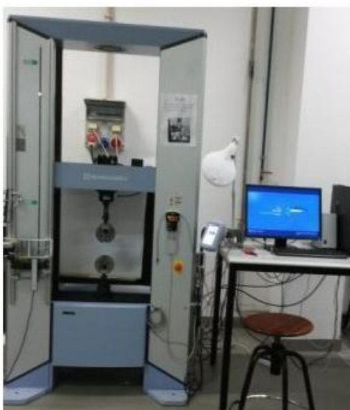
Figura 44 - Máquina de ensaios universal Shimadzu Autograph AG-X 100 e computador com software TRAPEZIUM X
