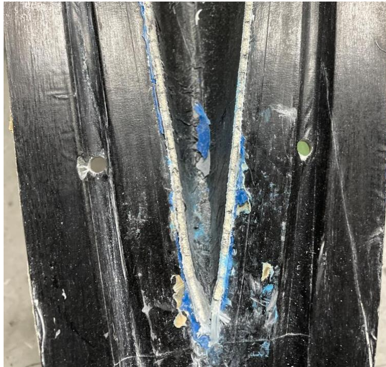
Figura 33 - Vista em detalhe da estrutura sandwich fabricada (K1)
