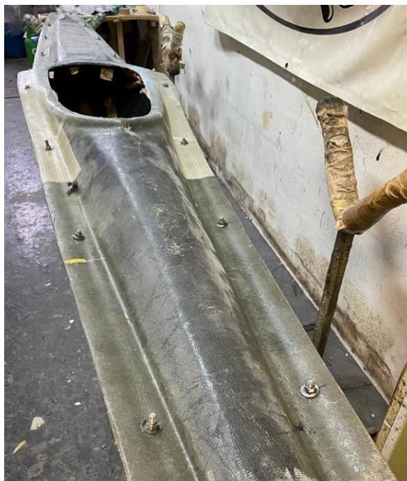
Figura 36 - Fecho dos moldes por aperto (K1)
