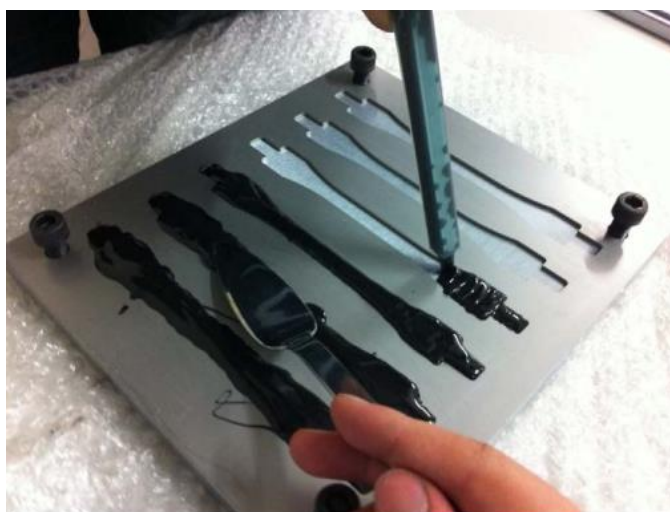
Figura 42 - Aplicação do adesivo por moldação em molde aberto
