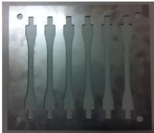
Figura 40 - Placa intermédia do molde (seis cavidades)
