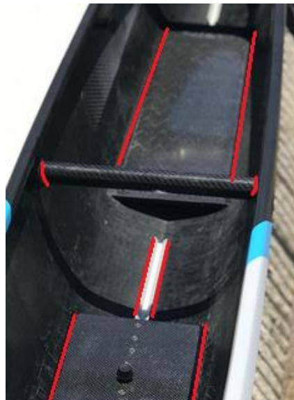
Figura 13 - Exemplo de ligação permanente numa Canoa (linha a vermelho)
