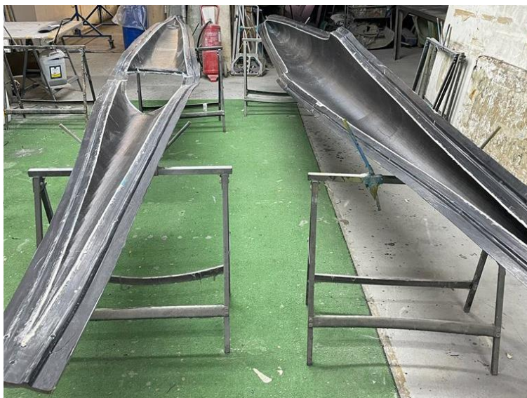
Figura 32 - Pós-cura das estruturas sandwich nos moldes, esquerda- deck e direita-casco (K1)
