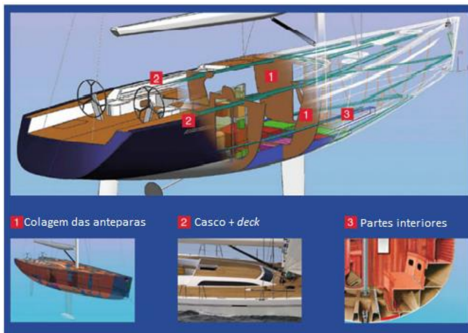
Figura 24 – Tipos de ligações adesivas em pequenas embarcações [118]
