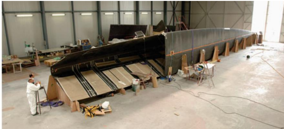
Figura 26 - Fabrico do casco de um barco de competição [118]
