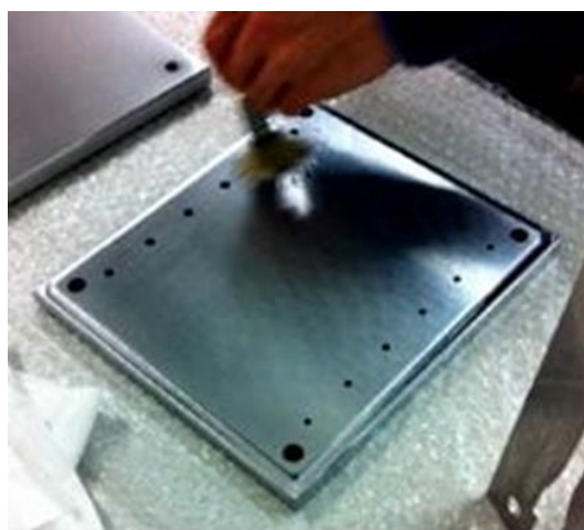
Figura 41 - Aplicação de desmoldante no molde
