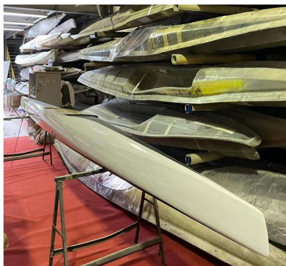
Figura 38 – Aspecto da junta adesiva fabricada após excesso de resina ser aparado e lixado
