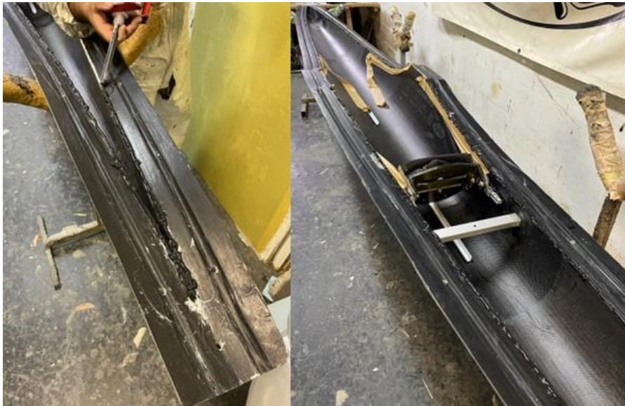
Figura 35 - Colocação de adesivo na junta
