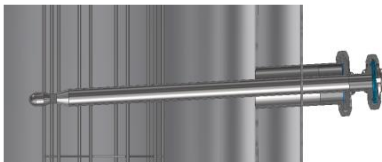
Figura 34 Modelo da pinha S20 instalada no Bag Filter
