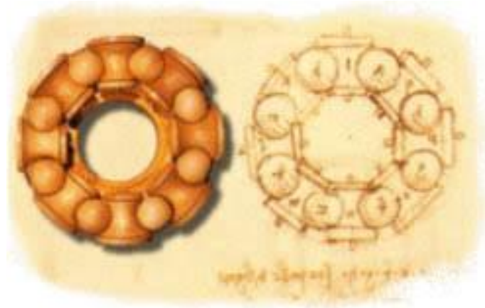
Figura 2: Rolamento idealizado por Leonardo Da Vinci (Retirado de [3])
