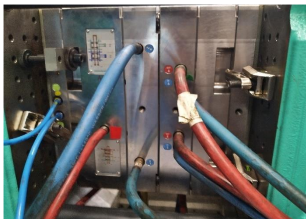
Figura 11 - Montagem de mangueiras de acordo com a cor da marcação
