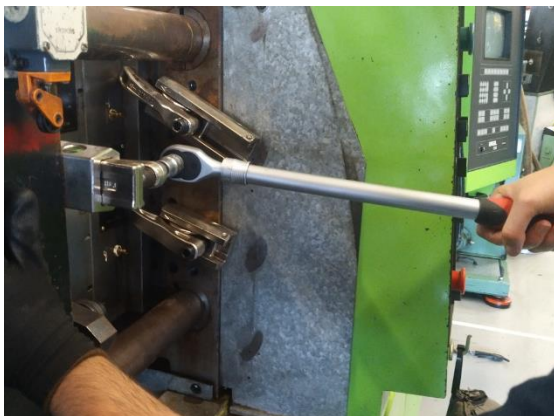
Figura 18 - utilização de roquete para aperto de grampos
