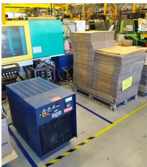
Figura 23 - Zona para termochillers marcada junto ao corredor
