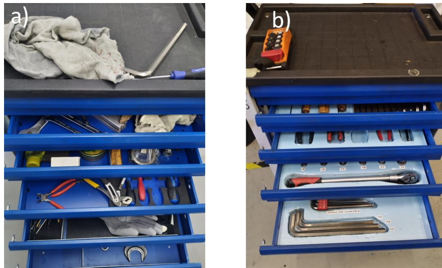
Figura 21 - Organização do carro de ferramentas antes a) e depois b)
