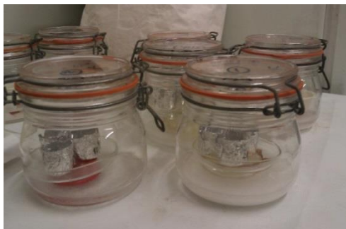
Figura 3.18 - Frascos utilizados no ensaio das isotérmicas de sorção.
