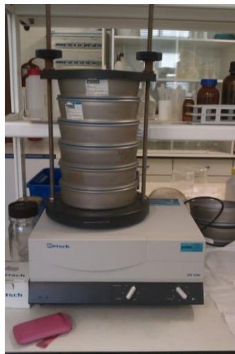
Figura 3.7 - Agitador de peneiros (AS200, RETSCH).
