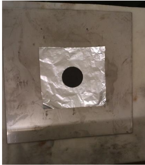
Figura 3.11 - Mistura em cima da folha de papel de alumínio e da placa da prensa.
