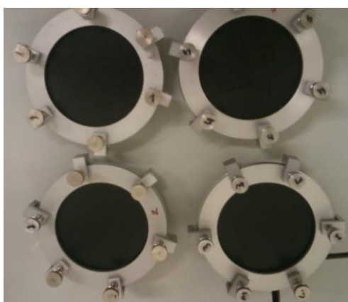
Figura 3.14 - Suportes utilizados no ensaio da permeabilidade ao vapor de água.
