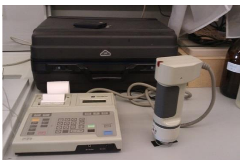
Figura 3.19 - Colorímetro (RS-232C, MINOLTA).
