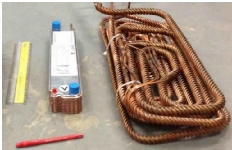
Figura 28 – Comparação entre os dois gas cooler , à esquerda o de placas e à direita o spiral [67]
