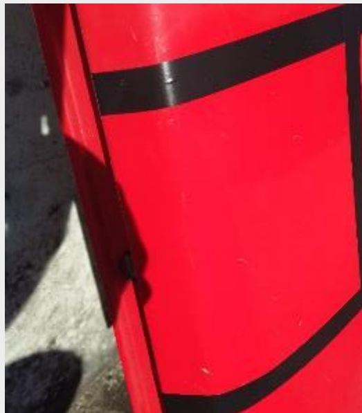
Figura 3-31- Detalhe de zona da superfície de ensaios. Superfície ficou livre de sujidade e brilhante.
