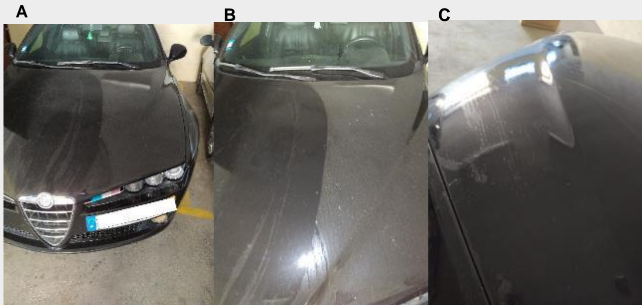
Figura 3-29- Viatura utilizada para testes com Diamond Blue ® . A - Aspeto do painel do capot imediatamente após aplicação; B - Detalhe imediatamente após aplicação, já com evidências de secagem do painel; C - 1 minuto após aplicação, verifica-se a formação de manchas. Remoção da sujidade foi eficaz.
