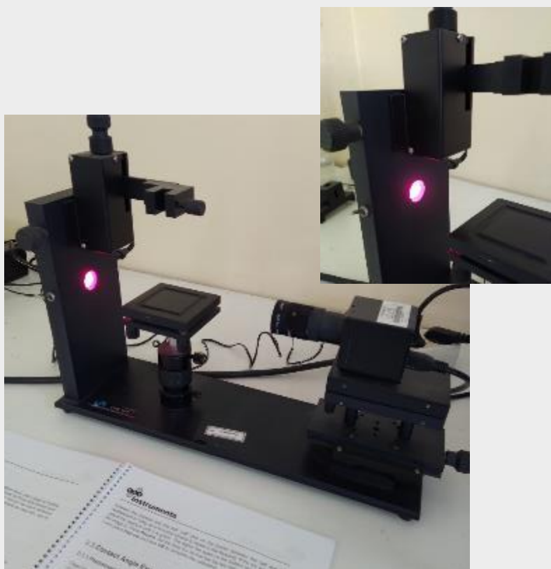
Figura 3-24 - Tensiómetro KSV Instruments CAM 101 e detalhe da câmara de infravermelhos, disponível no Laboratório de Tecnologia do ISEP.~
