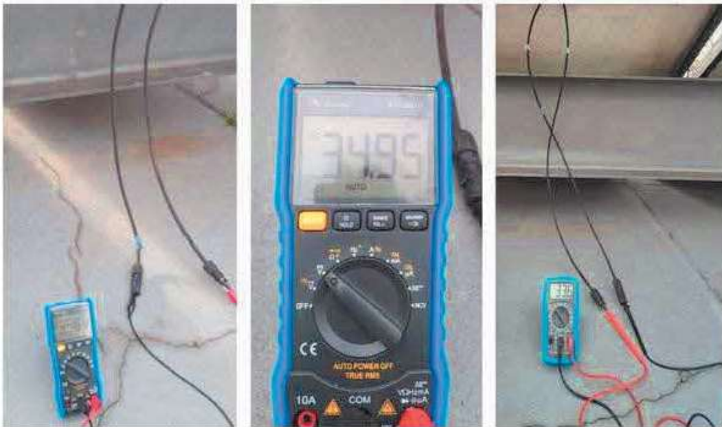
Figura 4 Valores das medições de Tensão de circuito aberto de cada equipamento. Os valores da esquerda para direita são 35.03, 34.95, 33.6 Vdc.
