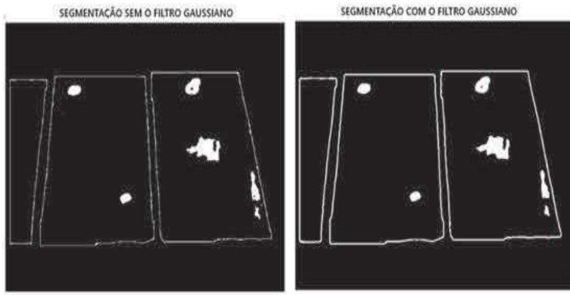
Figura 23 Segmentação por Threshold de espaço de cor HSV sem e com o filtro gaussiano x = 5 , y = 5 , \sigma = 10 .
