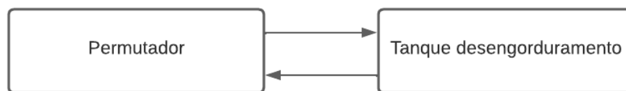
Figura 5.4 - Esquema da circulação da água de desengorduramento quando é aquecida no permutador
