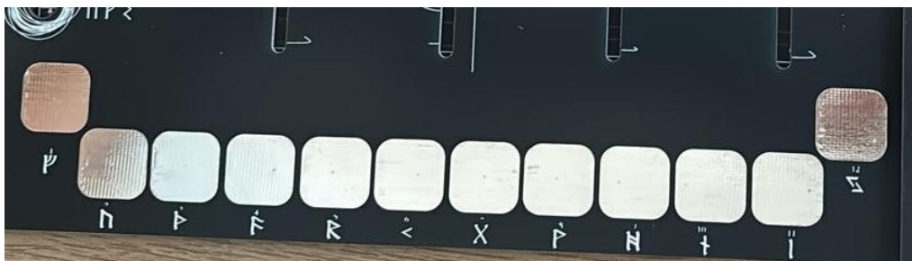
Figura 7- Os 12 pads capacitivos do VÆTTIR com as etiquetas rúnicas da escala Hirajoshi.
