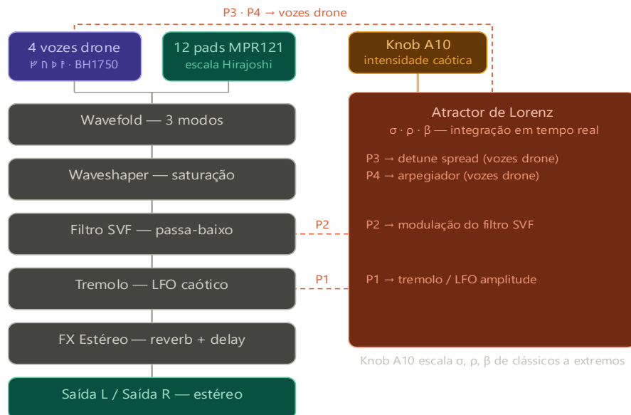
Figura 11- Diagrama do fluxo de sinal áudio do VÆTTIR
