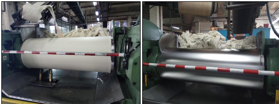
Figura 2.8. Misturador aberto "C 2". À esquerda vista frontal, à direita vista traseira do misturador.
