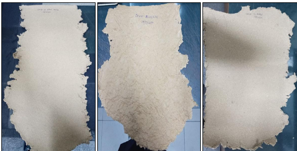
Figura 5.1. Misturas obtidas: À esquerda a Mistura Base+Casca de Arroz Moída, ao centro a Mistura Base+Couro Wet-White e à direita a Mistura Base+Casca de Arroz.
