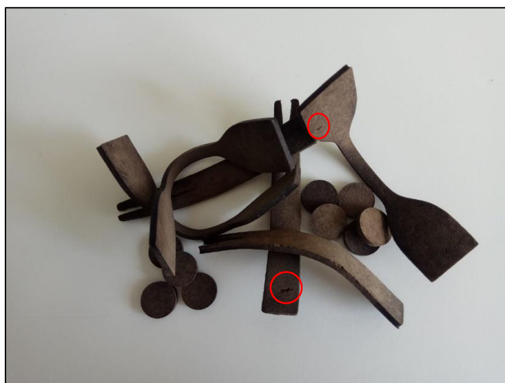
Figura 5.19. Provetes da mistura Base+Couro Wet-White, após biodegradação.
