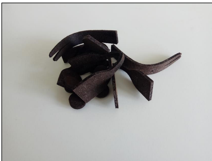
Figura 5.21. Provetes da mistura Base+Casca de Arroz Moída, após biodegradação.
