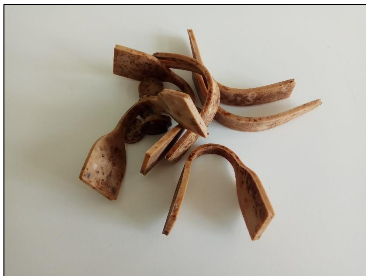
Figura 5.18. Provetes da amostra com Base, após biodegradação.
