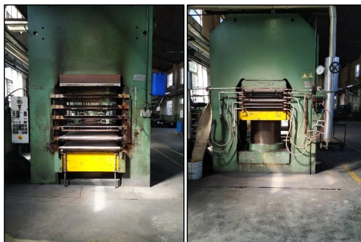
Figura 2.12. Prensas hidráulicas. À esquerda representação da prensa aberta, à direita prensa fechada.
