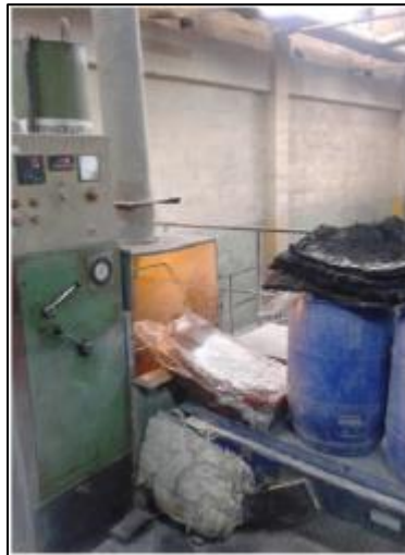
Figura 2.6. Parte superior do misturador interno "Werner & Pfleiderer".
