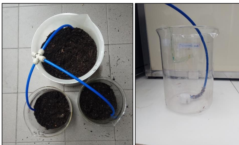
Figura 4.17. Passagem de ar para o produto de compostagem durante o tempo de ensaio.
