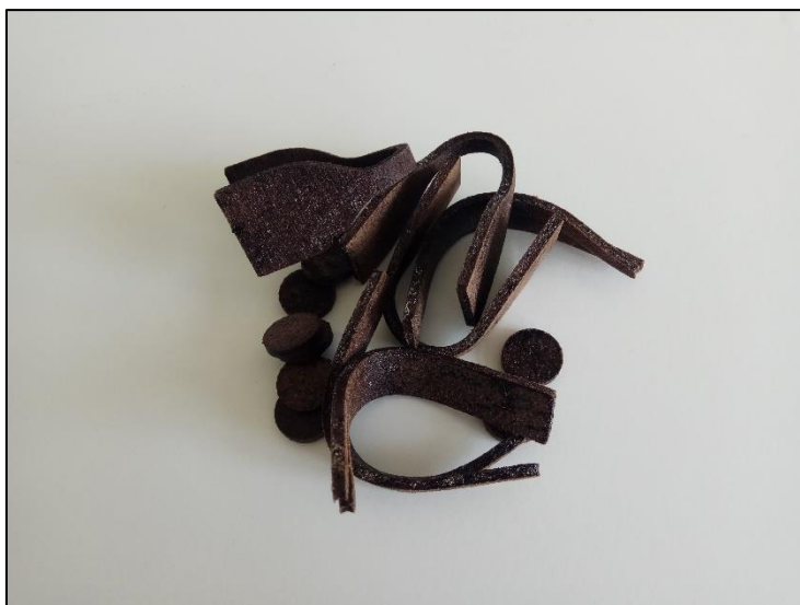
Figura 5.20. Provetes da amostra Base+Casca de Arroz, após biodegradação.
