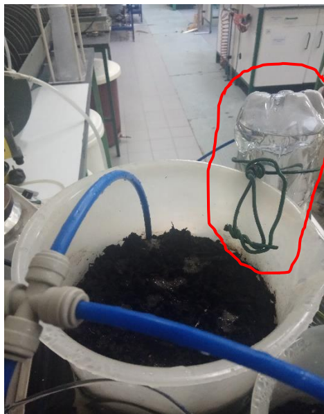
Figura 4.16. Instalação homemade com o pormenor de reposição de água.
