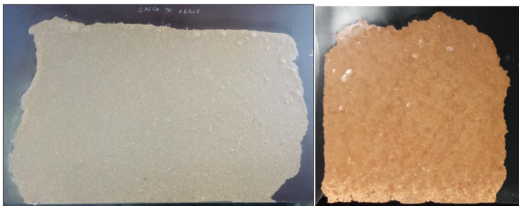
Figura 5.4. Vulcanização da mistura Base+Casca de Arroz à esquerda e da mistura Base+Couro Wet-White à direita.
