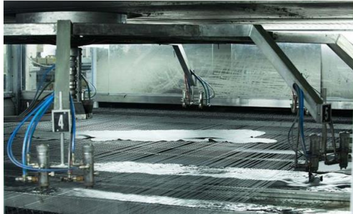
Figura 2.9 – Sistema de pintura por pulverização [7]
