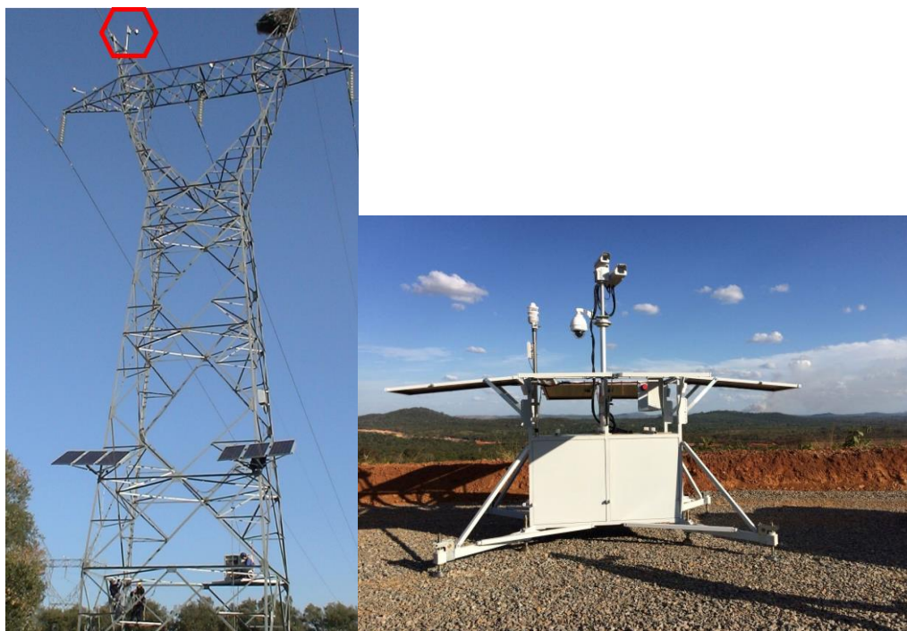
Figura 79 – Sistema integrado de vigilância e base para UAV (fonte: REN)
