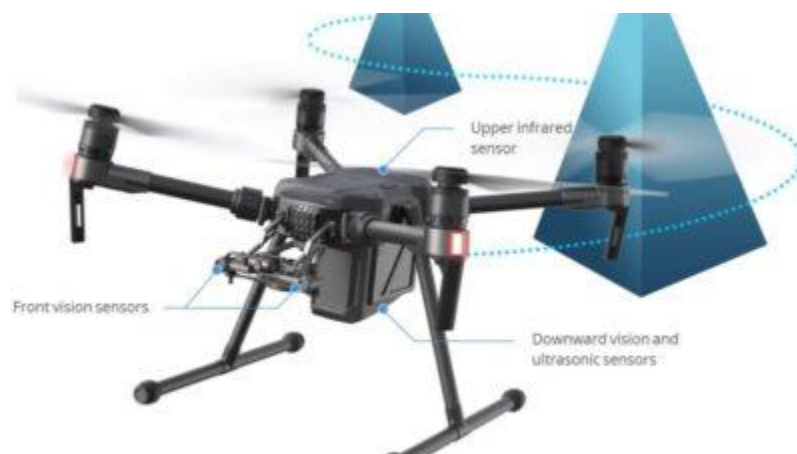
Figura 39 – Distribuição dos sensores anti colisão [36]
