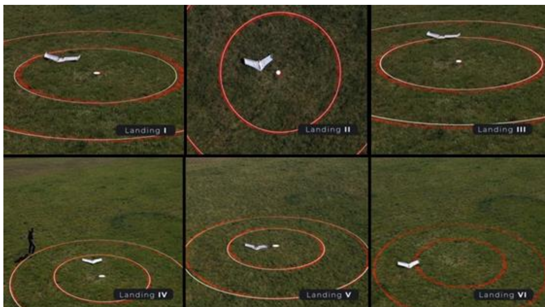
Figura 31 – Testes de precisão de aterragem automática dentro de um raio de 5 metros [32]
