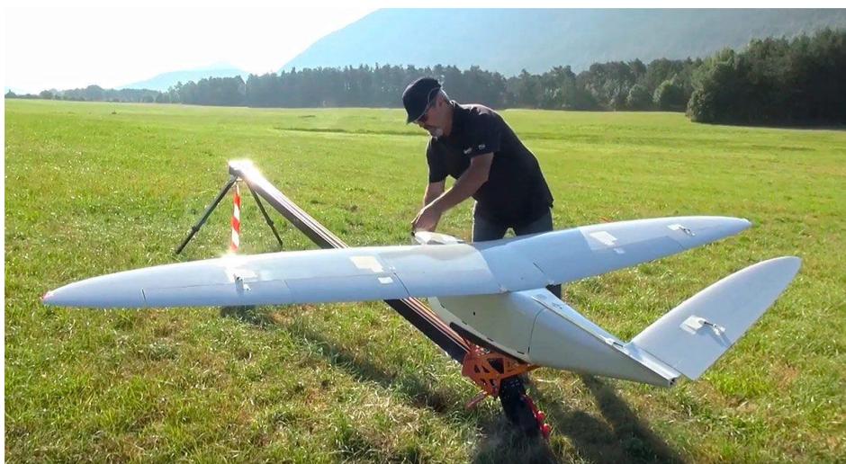
Figura 76 – RTE e Delair: mapeamento LiDAR recorrendo ao DT26 [91]
