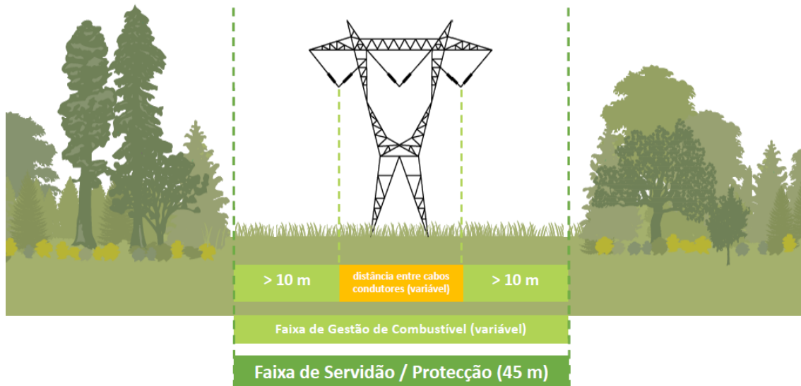
Figura 22 – Gestão da vegetação sob a faixa de servidão das linhas elétricas [20]
