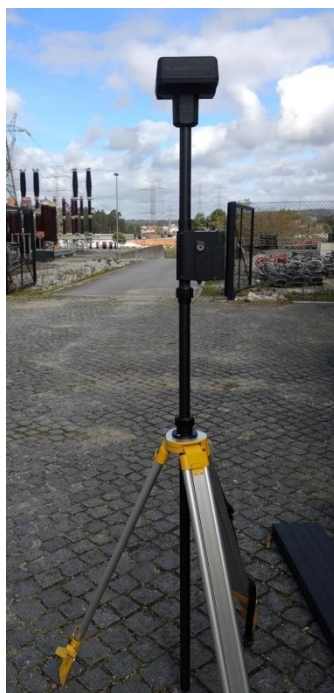
Figura 35 – Sistema RTK, desenvolvido pela DJI para o modelo Matrice 200 (fonte própria)
