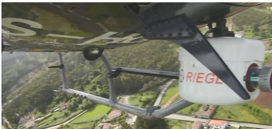
Figura 26 – Instrumentação LiDAR acoplada ao helicóptero (fonte: REN)
