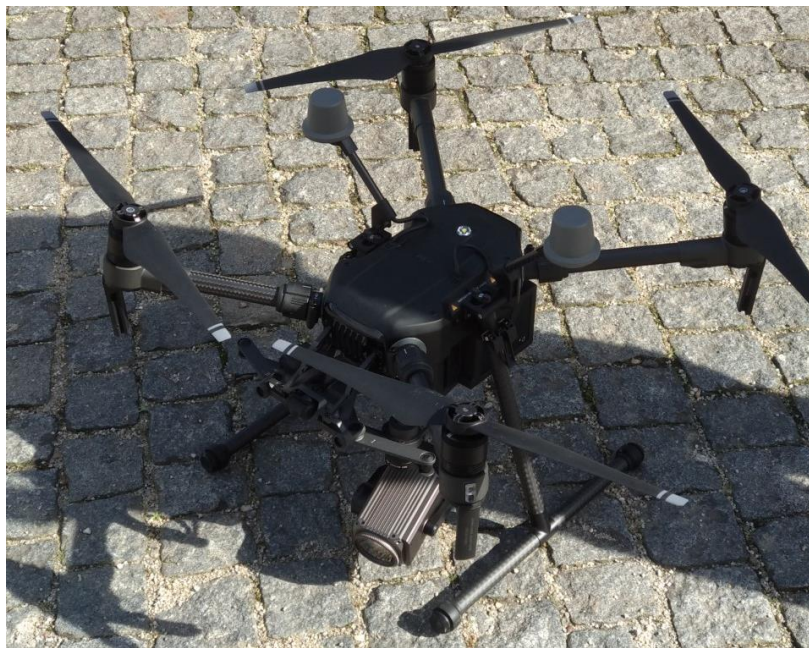
Figura 32 – DJI M210 RTK: UAV de asa rotativa (fonte própria)
