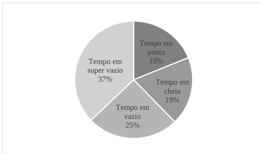
Figura 5.2 - Divisão do horário de funcionamento do gerador da olaria 2.1 pelos diversos períodos.
