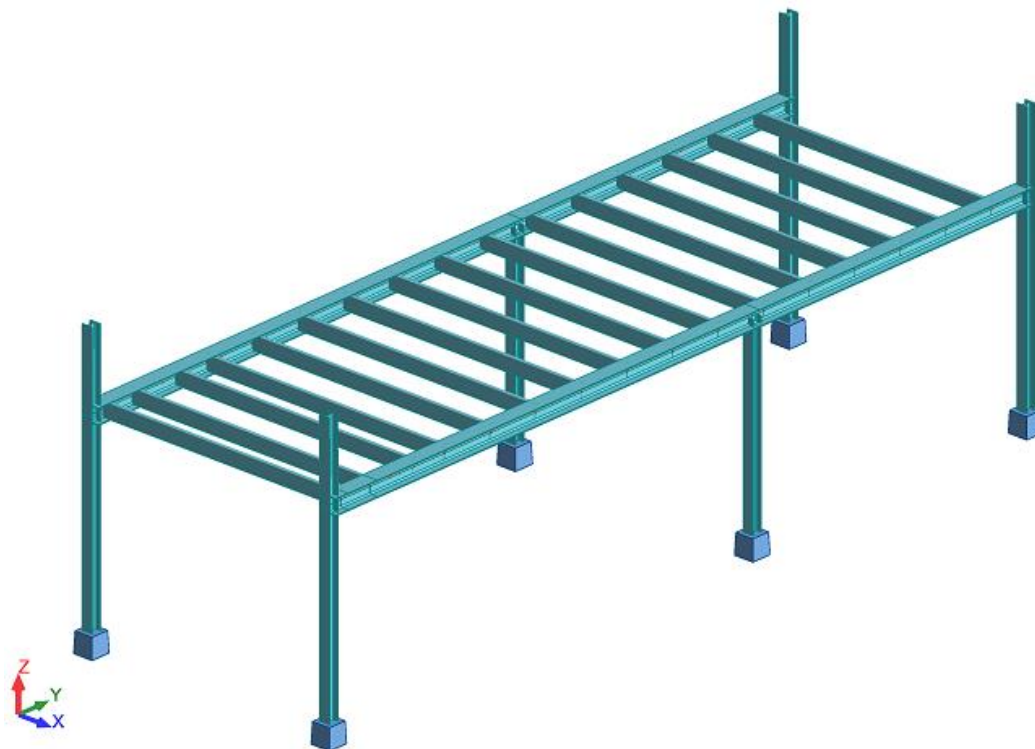
Figura 5.4 – Modelação das madres no pórtico com maior vão (Fonte: Robot Structural Analysis)
