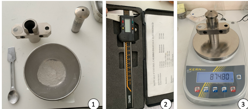
Figura 32- Material: (1) pistão, bloco, papel filtro, amostra, colher; (2) paquímetro digital; (3) Balança [erro 0,01 g].
