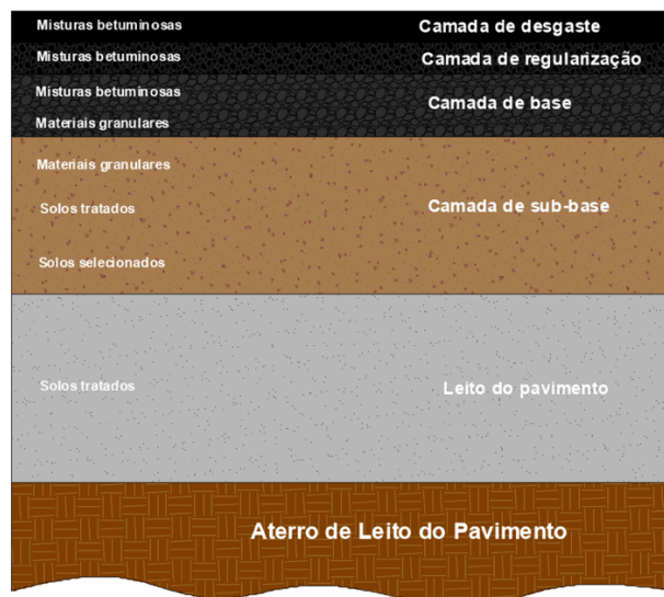
Figura 20- Esquema das camadas de um pavimento flexível. (adaptado de Santos, 2013)
