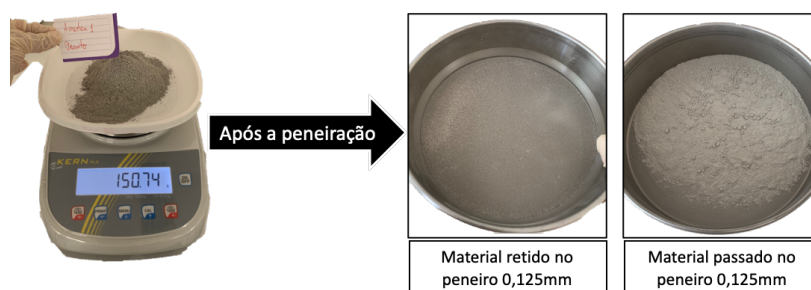
Figura 30- Preparação dos provetes: material após a peneiração.
