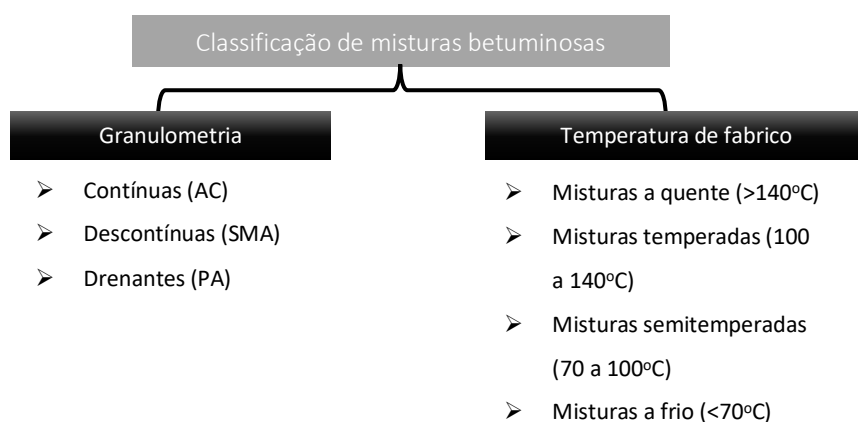
Figura 18- Esquema: Classificação de misturas betuminosas.
