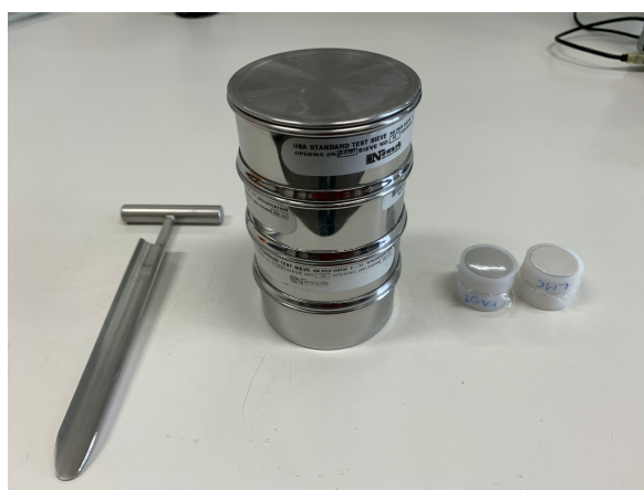
Figura 47-Material de ensaio: Amostrador-compactador, Peneiros, Cápsula com os provetes.
