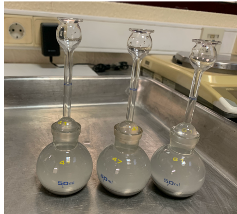
Figura 35-Picnómetros com água e fíler depois do banho.
