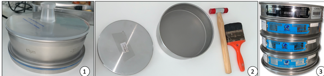
Figura 24- Material de ensaio: (1) peneiro 0,0063 mm com tampa transparente; (2) tampa de peneiros, fundo de peneiro, martelo e pincel; (3) série de peneiro.
