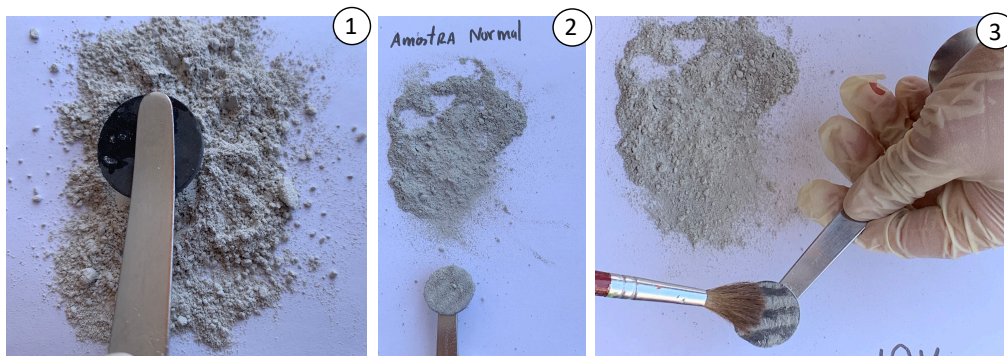
Figura 52- 1) Aproximação do íman à amostra LGV; 2) Amostra LGV e íman após passagem; 3) limpeza subtil com pincel para retirar excesso de partículas.
