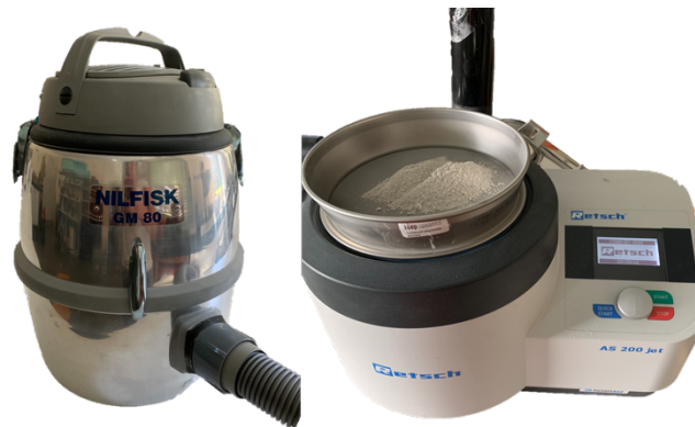
Figura 23-Aparelho de peneiração da jato de ar.
