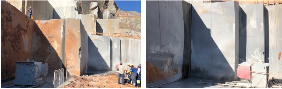
Figura 5 - Corte de rocha com fio diamantado. ( http://pt.keenwiresaw.com/Fio-superior-da-pedreira-do-granito-do-fio-do-diamante-da-qualidade.-11.5MM-37beads-pd6621228.html ).
