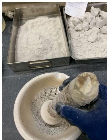
Figura 22-Desagregação das amostras após secagem.
