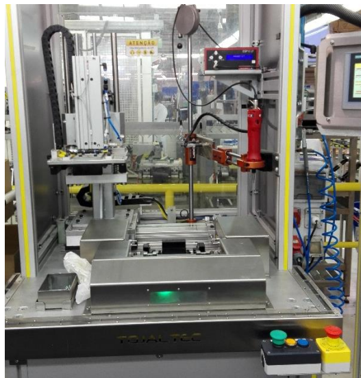
Figura 37 - Posto de Verificação e Aparafusamento
