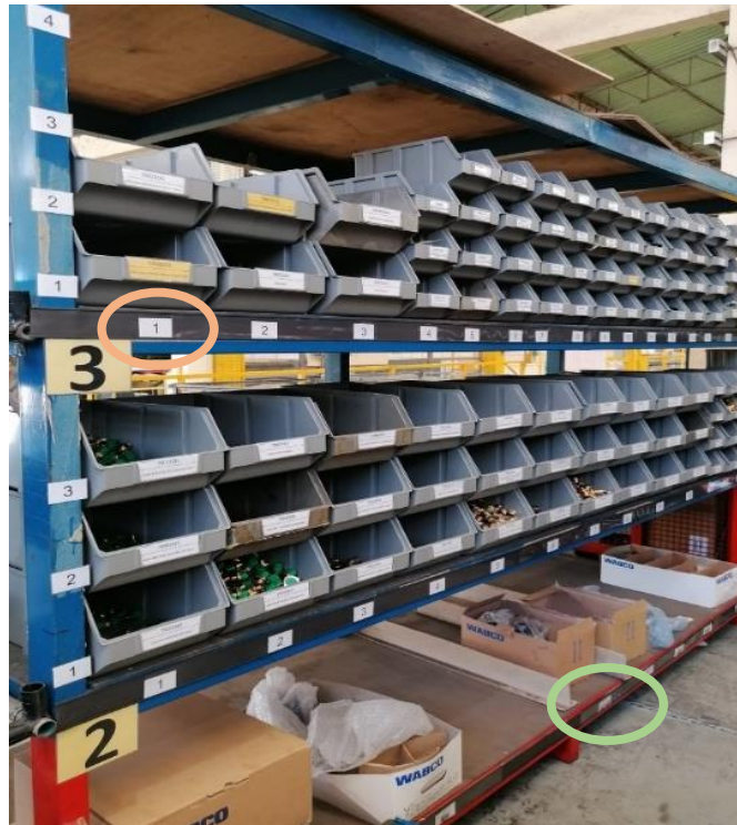
Figura 33 - Racks Destinadas ao Material de Menor Dimensão Identificadas com a Banda Magnética (Fonte: O Autor)
