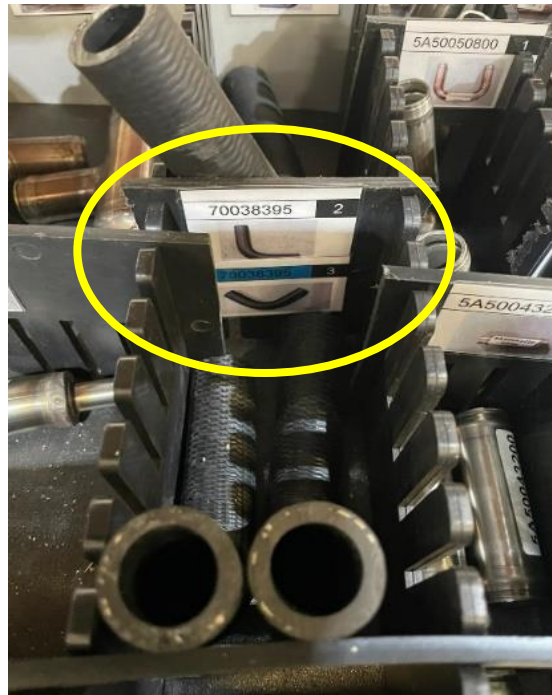
Figura 13 - Código de Cores para o Complemento de Carregamento OnBoard (Fonte: O Autor)
