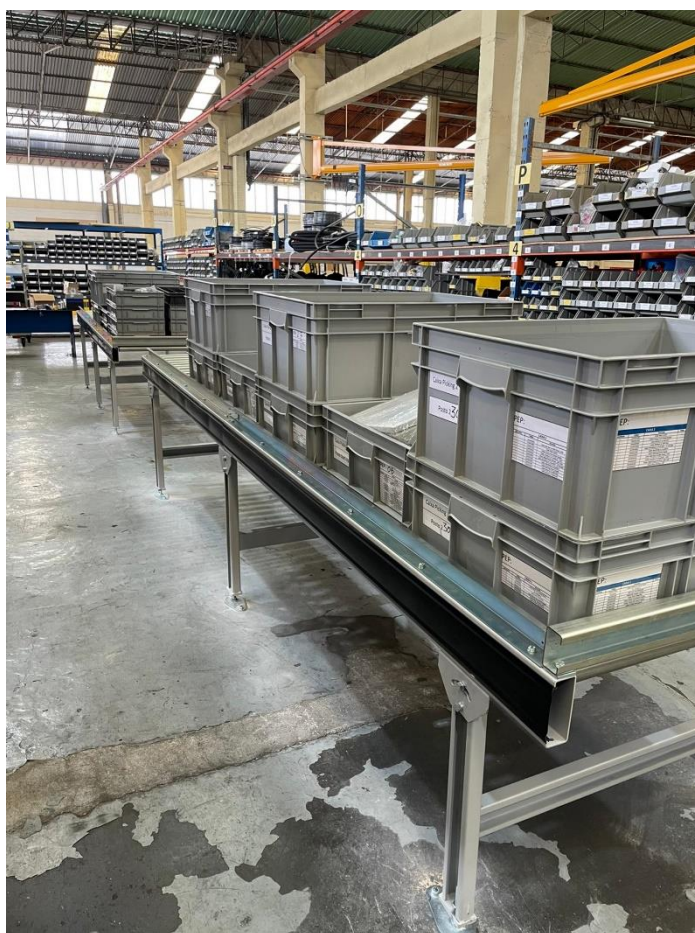
Figura 26 - Transportador de Rolos Livres para Armazenamento das Cablagens
