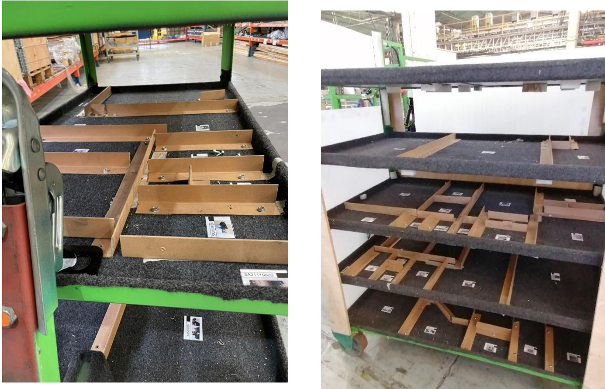
Figura 19 - Solução Final do Interior do Transportador de Peças Soltas de CBO (Fonte: O Autor)
