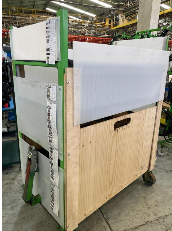
Figura 20 - Solução Final do Exterior do Transportador de CBO com a Respetiva Lista de Verificação (Fonte:
