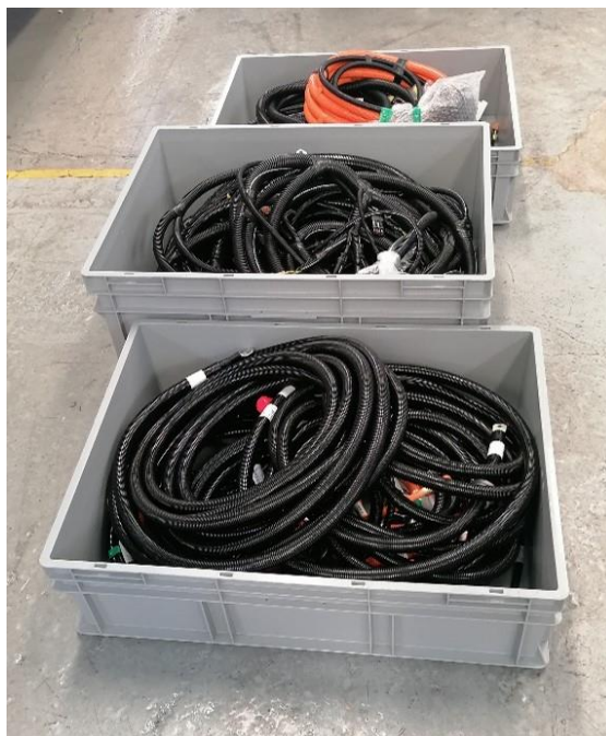
Figura 22 - Caixas para Picking das Cablagens (Fonte: O Autor)
