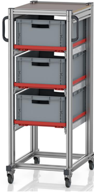
Figura 24 - Transportador para Abastecimento das Cablagens à Linha de Produção (Fonte: O Autor)
