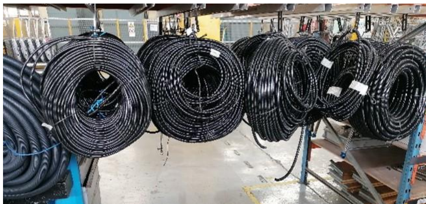
Figura 37 - Nova Solução para Armazenamento da Manga Pneumática (Fonte: O
