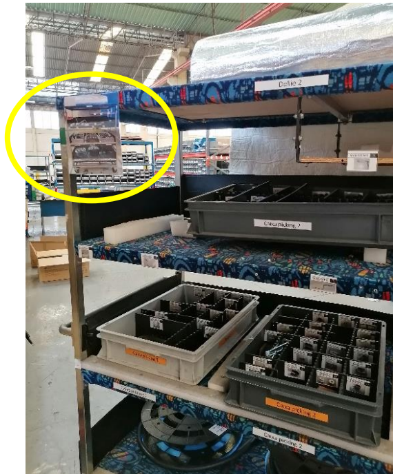
Figura 16 - Auxílio Visual para o Picking do Transportador do PT2 (Fonte: O Autor)
