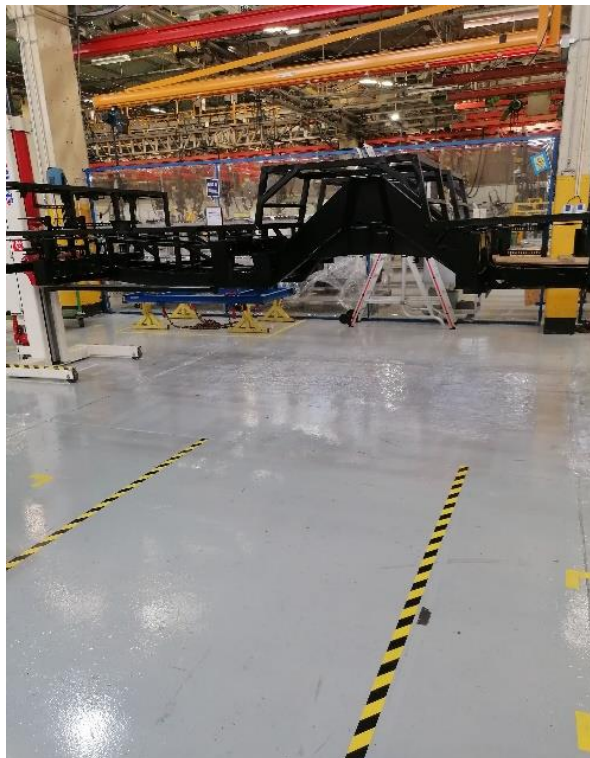
Figura 50 - Corredor de Segurança para Entrada do Stacker na Linha (Fonte: O Autor)
