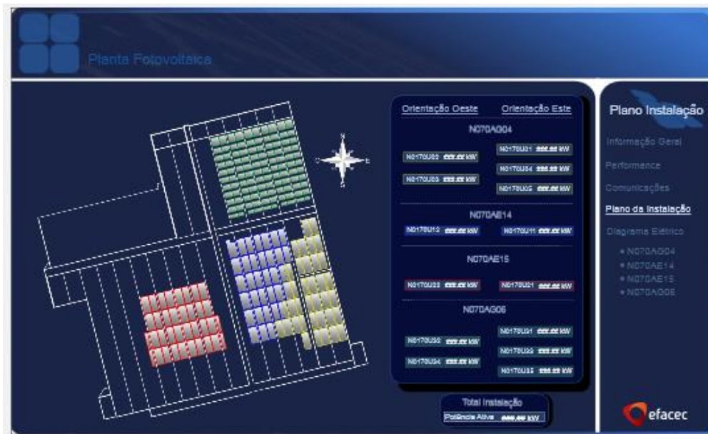
Figura 32: Layout de monitorização de uma instalação.
