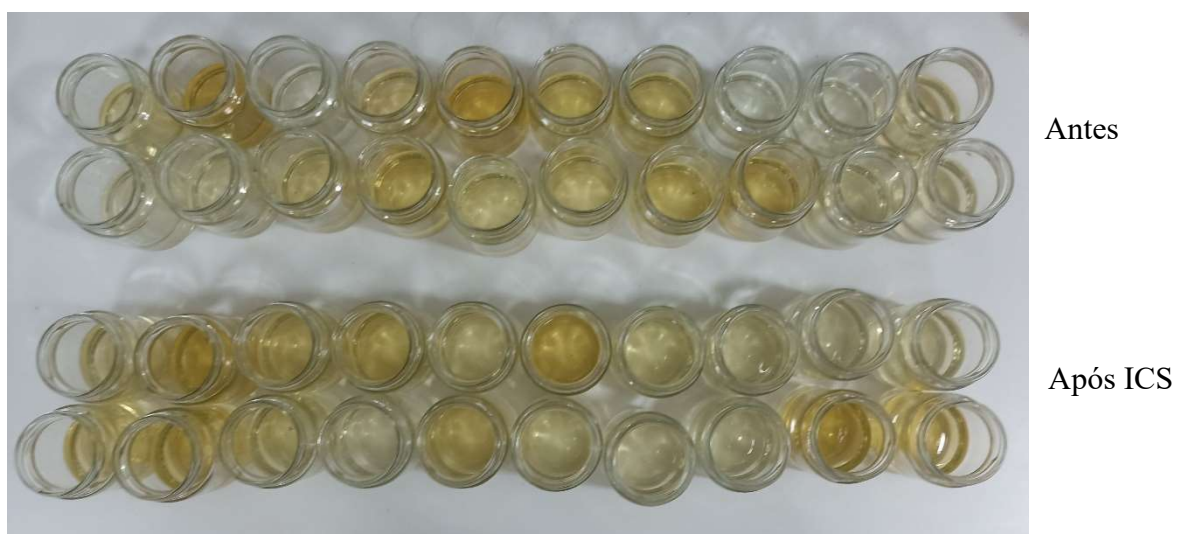
Figura 6.32 – Solução de maceração individual de rolhas de antes (n=20) e após ICS (n=20) durante 72 horas para análise de absorvância do ensaio P11-2
