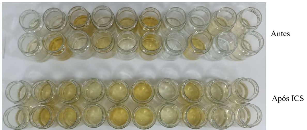
Figura 6.31 – Solução de maceração individual de rolhas de antes (n=20) e após ICS (n=20) durante 72 horas para análise de absorvância do ensaio P11-1
