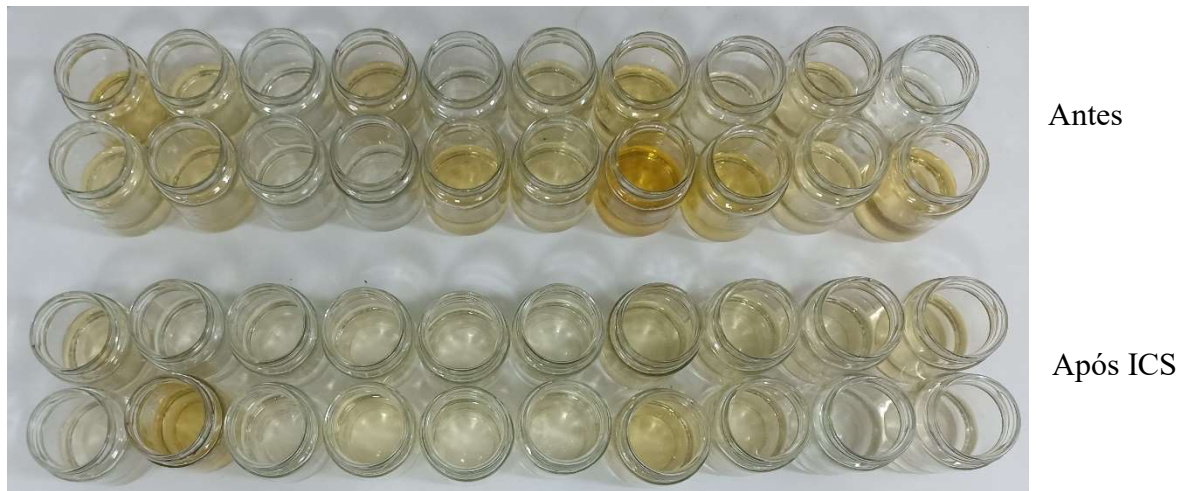
Figura 6.31 – Solução de maceração individual de rolhas de antes (n=20) e após ICS (n=20) durante 72 horas para análise de absorvância do ensaio P11-1
