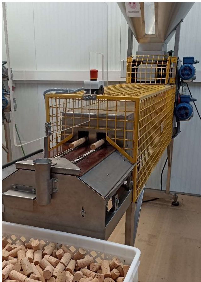
Figura 5.8 – Equipamento de controlo Sniffing
