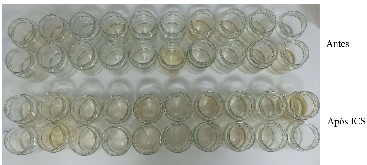
Figura 6.35 - Solução de maceração individual de rolhas de antes (n=20) e após ICS (n=20) durante 72 horas para análise de absorvância do ensaio P11-5
