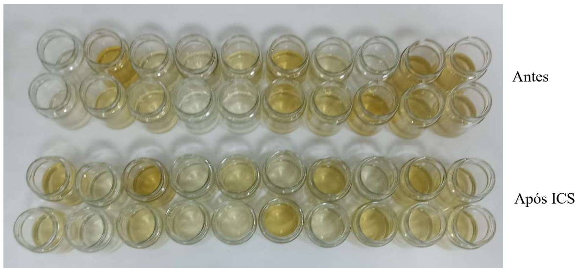
Figura 6.34 – Solução de maceração individual de rolhas de antes (n=20) e após ICS (n=20) durante 72 horas para análise de absorvância do ensaio P11-4
