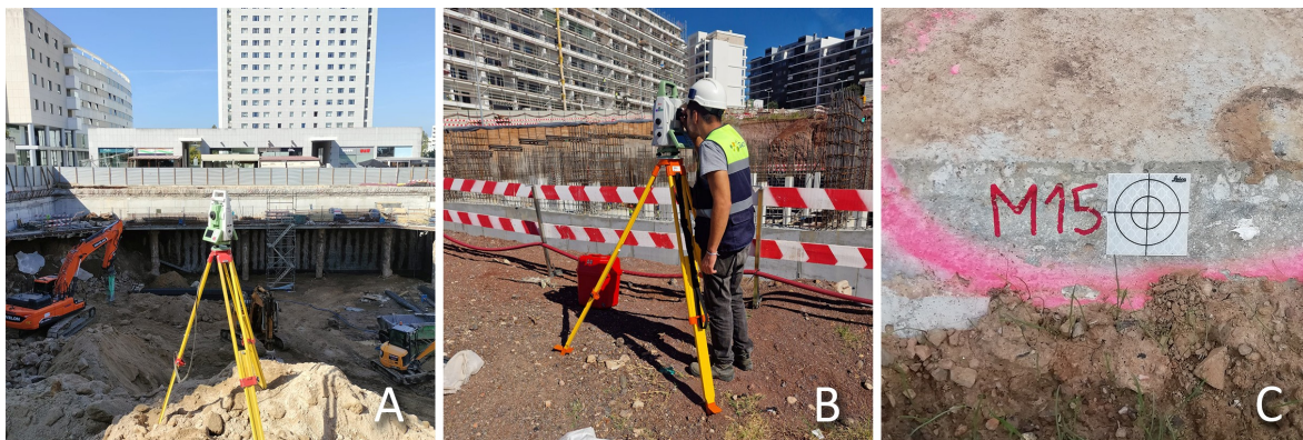
Figura 6 – (A) Taqueómetro (estação total); (B) Aquisição manual de dados com estação total; (C) Alvo topográfico (fotografias do autor)
