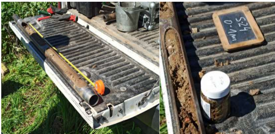
Figura 25-Amostrador com amostra de solo e frasco com amostra de solo da sondagem S24
