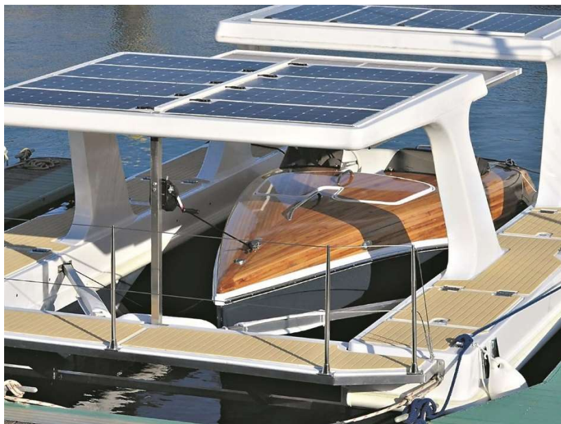
Figura 75 - Doca flutuante para carregamento de embarcações elétricas
