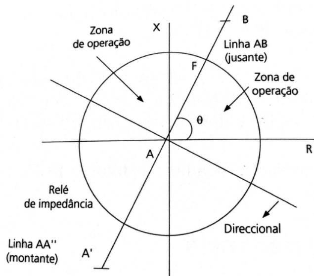
Figura 27: Diagrama do relé de impedância com unidade direcional [5]
