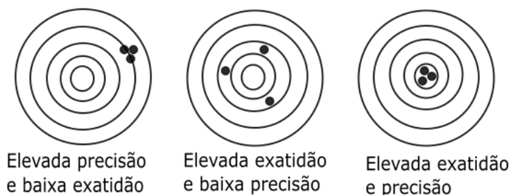
Figura 5 – Ilustração representativa da diferença entre exatidão e precisão (adaptado de Dunnicliff, 1988)
