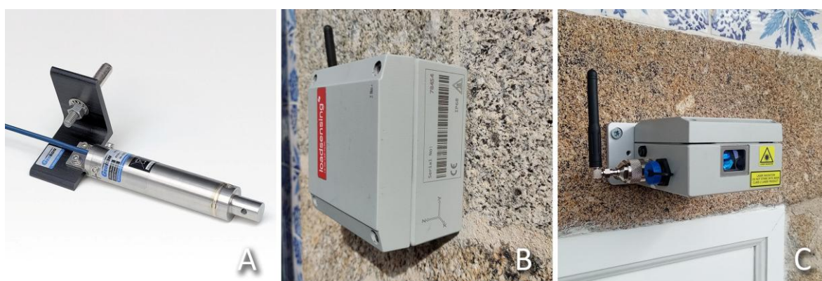
Figura 12 – (A) Tiltmeter uniaxial de corda vibrante (Geokon, 2025); (B) Wireless tiltmeter triaxial; (C) Wireless tiltmeter triaxial associado a sistema laser para medição de distância (fotografias do autor)
