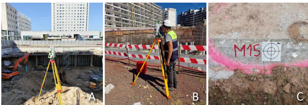
Figura 6 – (A) Taquímetro (estação total); (B) Aquisição manual de dados com estação total; (C) Alvo topográfico (fotografias do autor)
