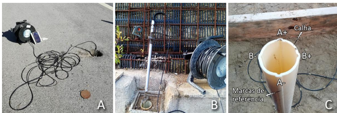
Figura 7 – (A) Aquisição manual de dados com sonda inclinométrica; (B) Redundância de leituras entre inclinómetro vertical e prisma topográfico; (C) Calha inclinométrica com marcas de referência e orientação de leitura (fotografias do autor)
