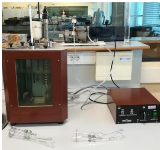
Figura 4.11 - Montagem experimental utilizada para a calibração do viscosímetro de Cannon-Fenske.
