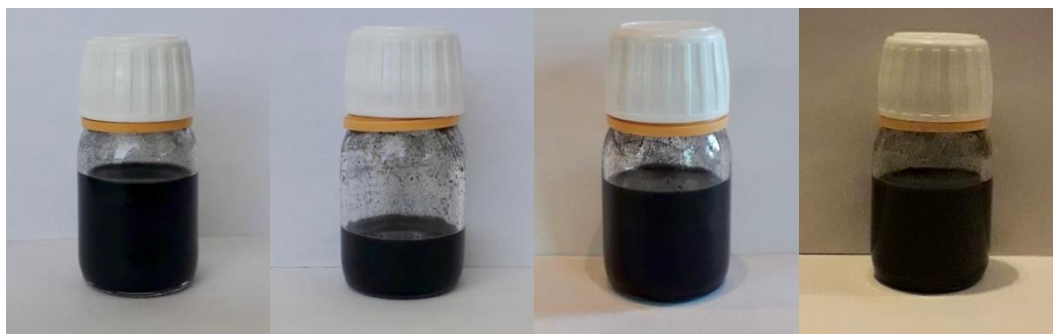
Figura 5.1 - Avaliação da estabilidade do nanofluido de 0.1% grafeno em etilenoglicol a 0h, 3h, 6h e 9h, respetivamente.
