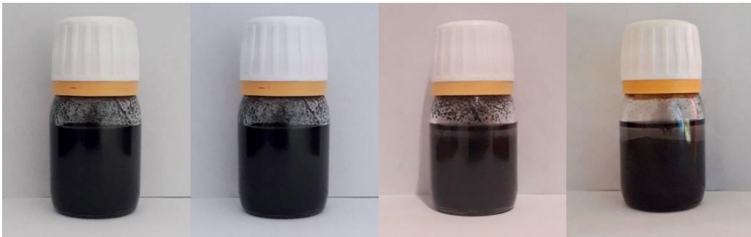
Figura 5.3 - Avaliação da estabilidade do nanofluido de 0.2% grafeno em etilenoglicol a 0h, 24h, 48h, 72h, respectivamente.
