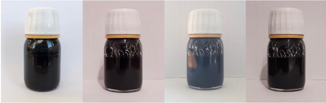
Figura 5.5 - Avaliação da estabilidade do nanofluido de 0.5% grafeno em etilenoglicol a 0h, 24h, 48h, 72h, respetivamente.
