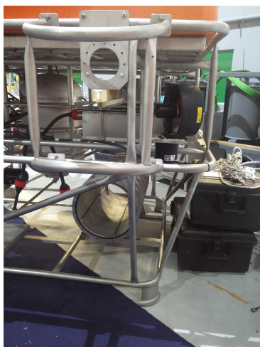
(a) Estrutura de proteção dos thrusters .
