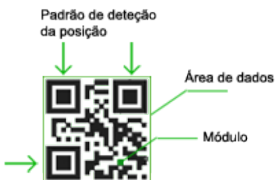
Figura 8 – Estrutura do QR Code
