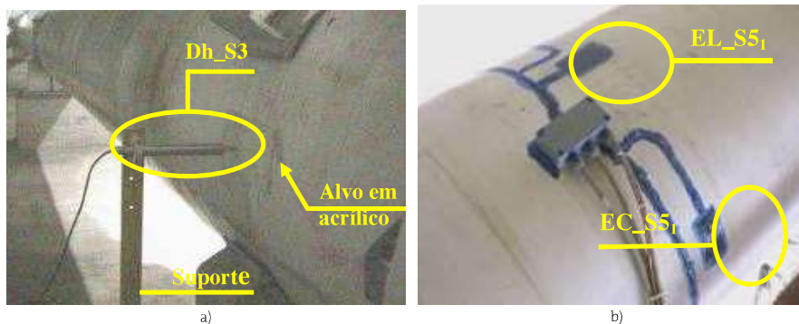
Figura 7 Instrumentação: a) LVDT na secção S3 e b) extensómetros na secção S5: EL_S51 e EC_S51
